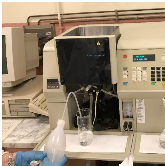
Figura 26: espectrofotómetro de absorción atómica utilizado para la determinación de cobre disponible en los suelos.
