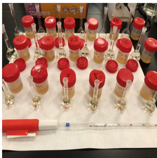
Figura 25: Preparación de las diluciones del sobrenadante para determinar el contenido de cobre disponible en los suelos.
