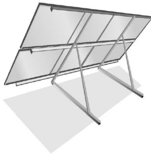
Figura 38 : instalación fotovoltaica fija. [29]
