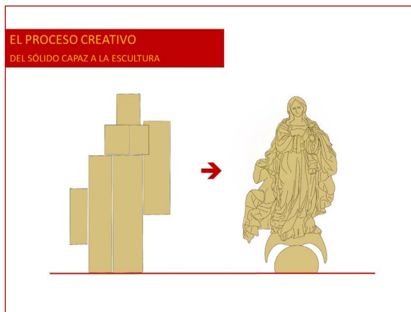
Ilustración 2. Este gráfico representa a la izquierda el embón o sólido capaz de la obra y a la derecha la escultura en soporte una vez tallada.
