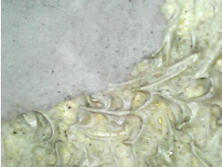
Figura 15: Microfotografía de una de las manchas de pintura sobre la capa de protección. Aumento 1600X. Fotografía: Gloria Rodríguez
