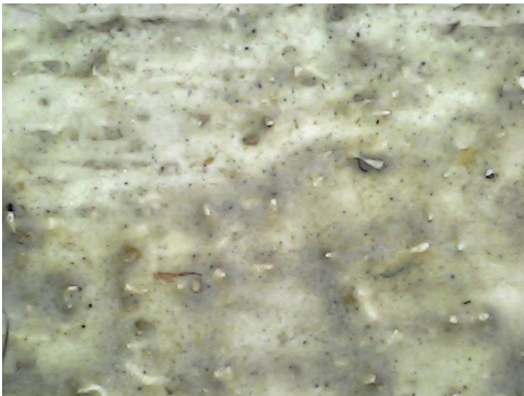
Ilustración 12: Microfotografía de las acumulaciones de barniz presentes en el tablero 2. Aumento 1600X. Fotografía: Gloria Rodríguez
