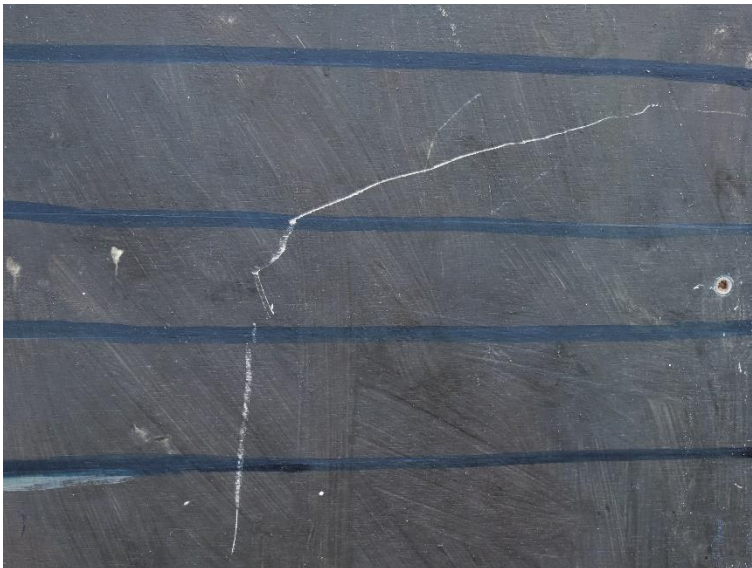
Figura 10: Detalle de los desgastes provocados por roces. Fotografía: Gloria Rodríguez
