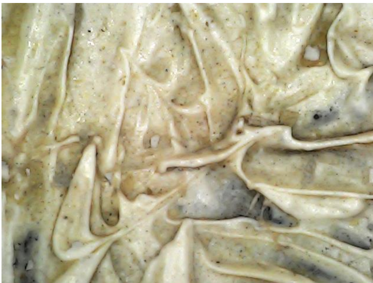
Ilustración 9: Microfotografía del empaste presente en el tablero 3. Aumento 1600X. Fotografía: Gloria Rodríguez
