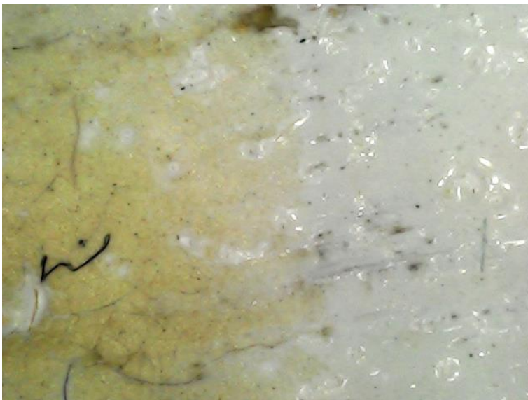
Figura 16: Microfotografía de una salpicadura amarillenta sobre la capa de protección del tablero 3. Aumento 1600X. Fotografía: Gloria Rodríguez
