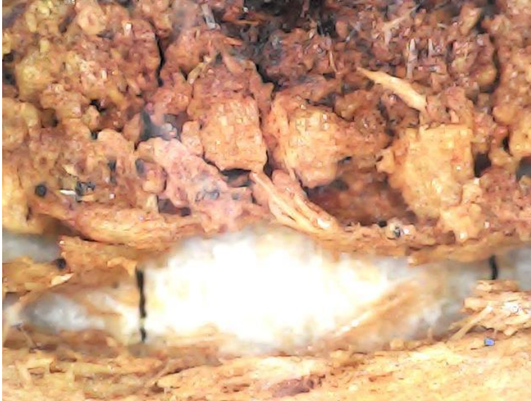
Figura 9: Microfotografía de un nudo en el tablero 3 a punto de saltar. Aumento 1600X. Fotografía: Gloria Rodríguez
