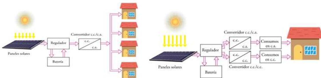
Figura 2-4. Instalación centralizada (izquierda) e instalación descentralizada (derecha)
