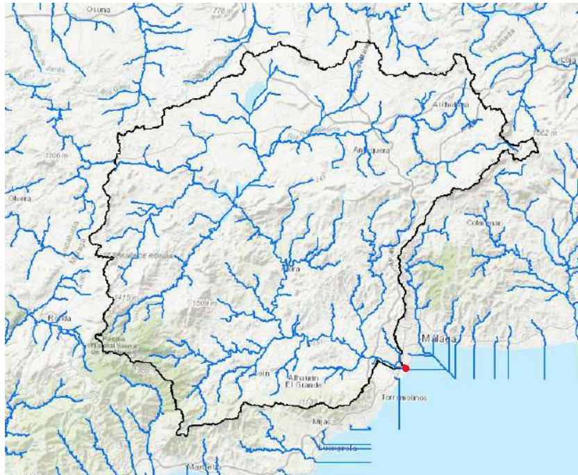
Ilustración 2-14: Red Hídrica y punto de desagüe de la cuenca del río Guadalhorce
