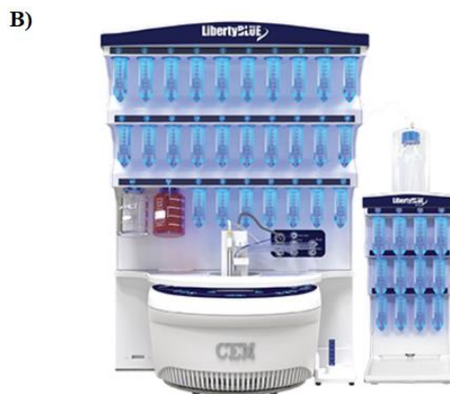
Figura 1.10. A) Representación esquemática de la SPPS. B) Imagen del sintetizador automático de péptidos Liberty Blue HT12™ (CEM Corporation), uno de los más avanzados del mercado.
