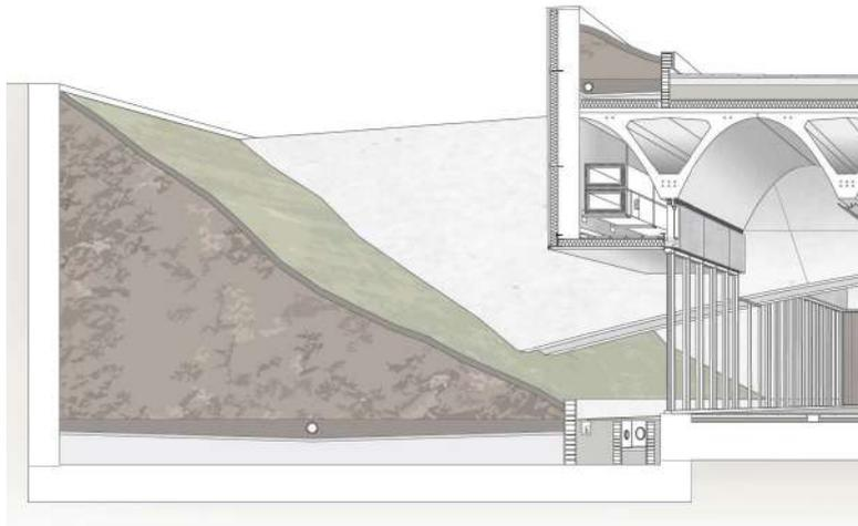
En la imagen podemos ver en sección el sistema de recogida del patio del Pabellón, idéntico al de los patios sur del Garaje. En ellos el agua mediante tubos de drenaje bajo los ajardinamiento y mediante sumideros lineales en el extremo de los mismos
