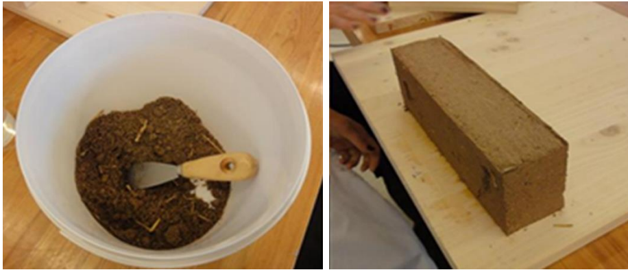
Fig. 39. Muestra fabricada para la caracterización experimental de la solución avanzada de tierra apisonada con PCM microencapsulado. Fuente: [57]
