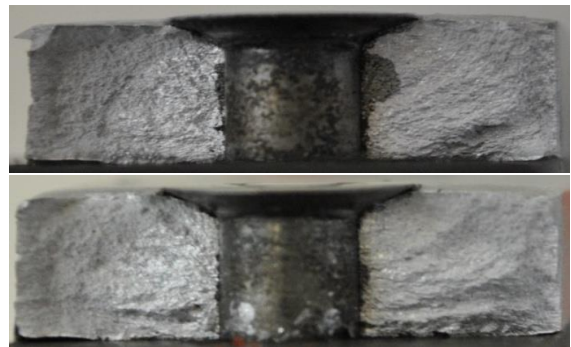
Fig. 11. Fractografía en probetas MLT sin rebaba (arriba) y con rebaba (abajo) a 14,5 kN.
