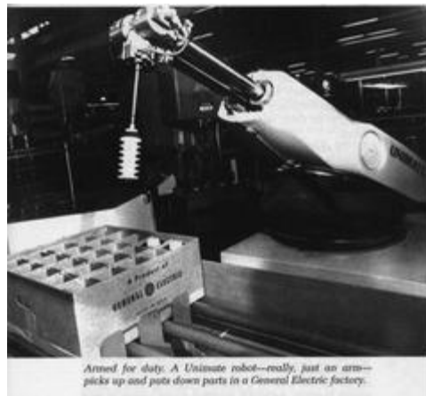
Figura 1-1. Primer robot Industrial “Unimate”
