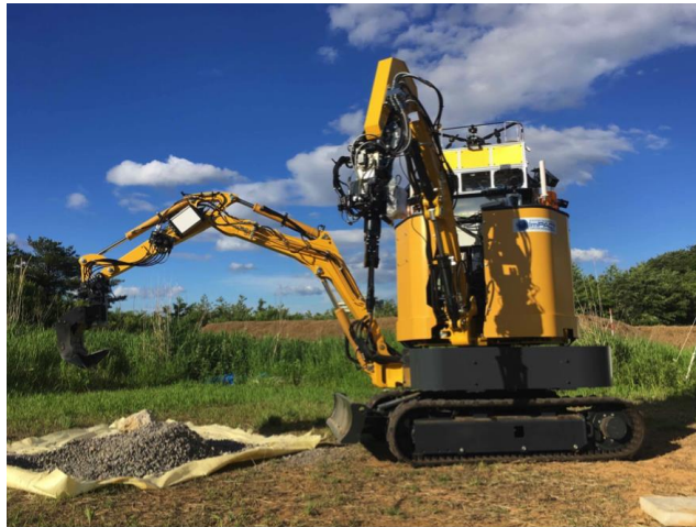
Figura 1-6. Robot de construcción de doble brazo con función de control remoto.
