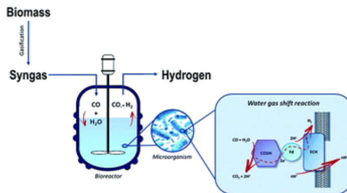
Figura 4. Reacción de Water Gas Shift. FUENTE [37]
