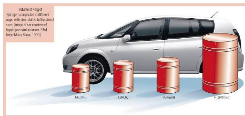
Figura 7. Volumen que ocupa una masa de H 2 de 4kg en función del tipo de almacenamiento.
