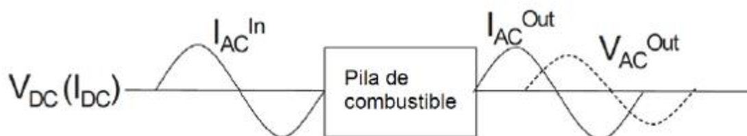
Figura 23. Esquema conceptual de un experimento de impedancia electroquímica. FUENTE [12]
