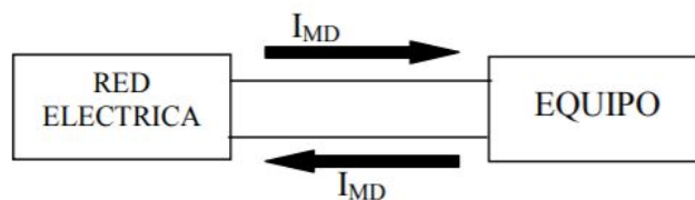
Figura 1.4 Corrientes en modo diferencial.
