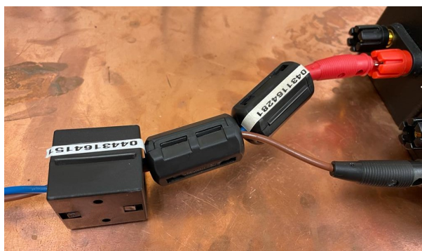
Figura 6.5 Disposición abrazaderas en el set-up de medida.
