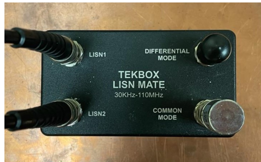
Figura 3.5 LISN Mate. Discriminador de modo común y diferencial .
