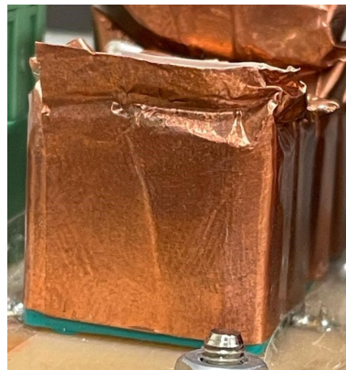
Figura 5.4 Láminas de cobre sin ser insertadas completamente entre los componentes acoplados.
