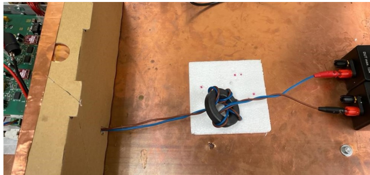
Figura 6.3 Disposición núcleo de ferrita.
