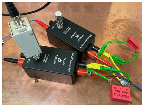
Figura 3.2 LISN de 5 \mu\text{H} con condensadores de 3.3 \mu\text{F} a la entrada.
