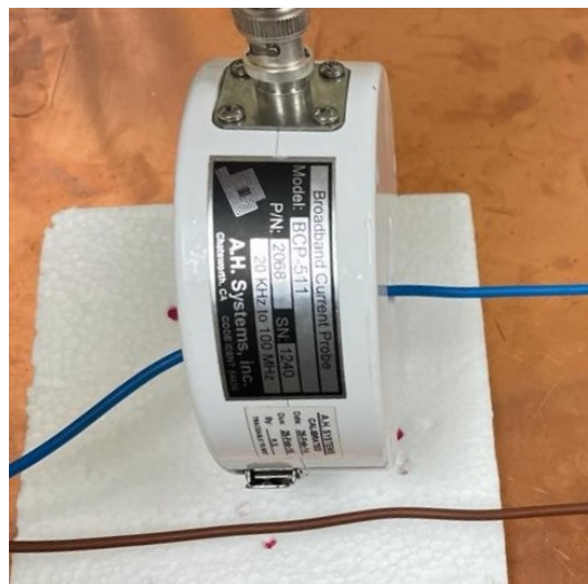
Figura 7.2 Disposición de la sonda y los cables para la toma de medidas de la emisión total.
