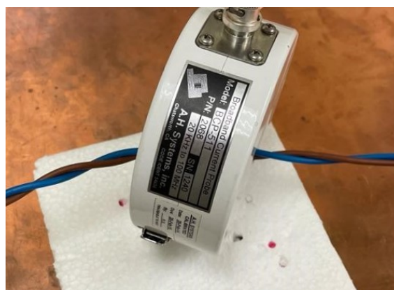
Figura 7.3 Disposición de la sonda y los cables para la toma de medidas de emisiones en modo común.
