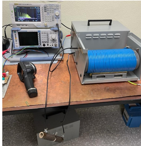
Figura 3.1 LISN para normativa MIL-STD-461 conectados a carga de de 12 \Omega .
