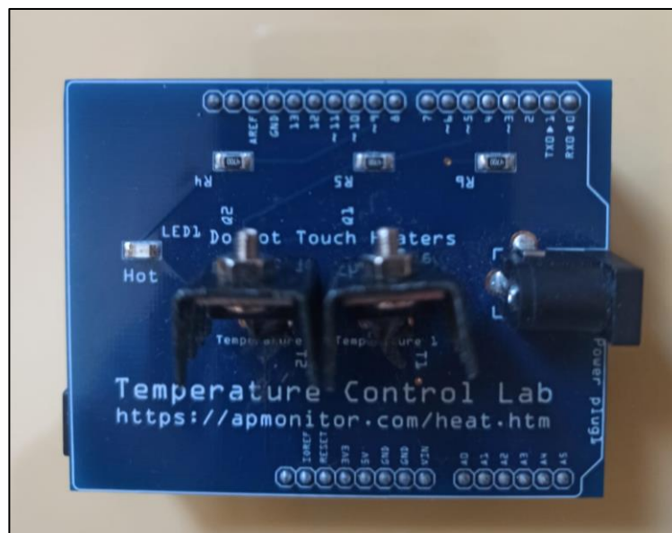
Figura 2-1. Vista superior del TCLab.
