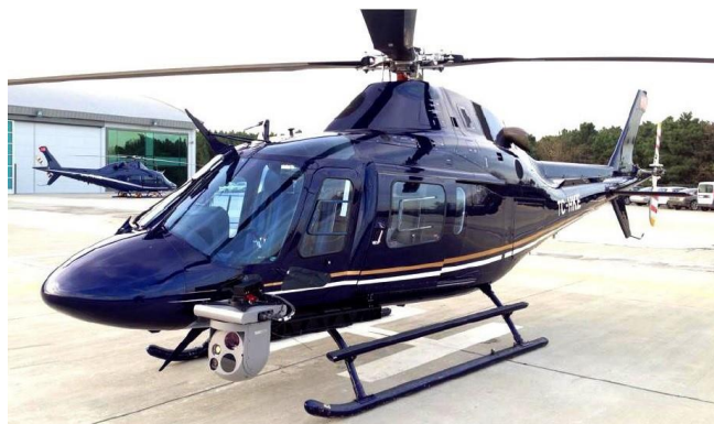
Figura 6. Helicóptero equipado con sensores estabilizados de infrarrojos y ultravioleta para detectar puntos calientes y emisiones del efecto corona.
