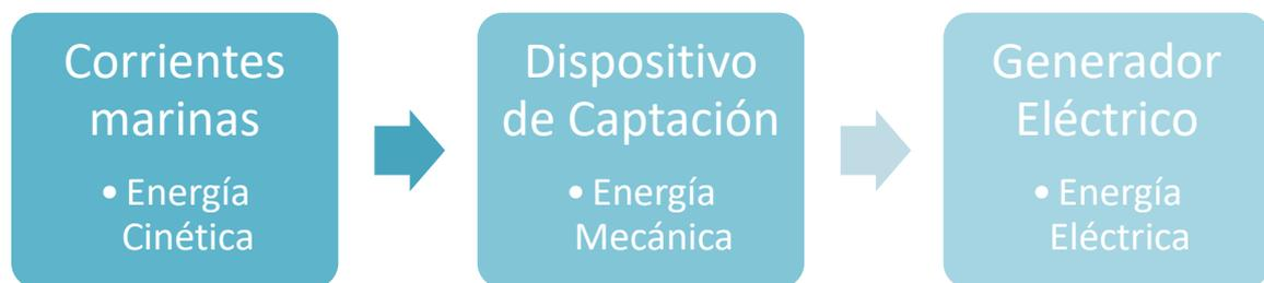
Figura 5-2. Esquema general de conversión de energía por corrientes marinas
