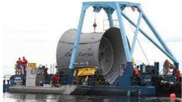
Figura 5-6. Turbina Generador de Marea de Clean Current [27]
