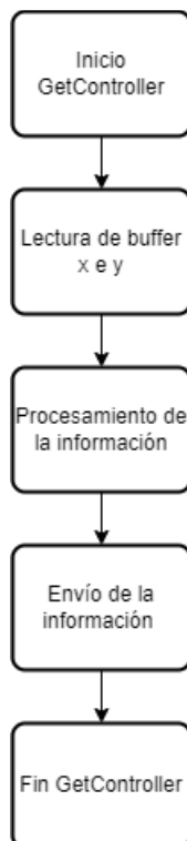
Figura 4-9. Diagrama de flujo de GetController
