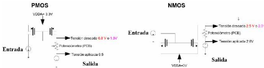
Figura 6-6. Esquema empleado para ajustar los valores de los potenciómetros en la salida de los espejos de corriente.
