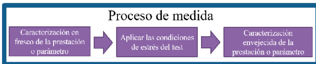
Figura 4-1. Proceso de medida de un experimento de fiabilidad.
