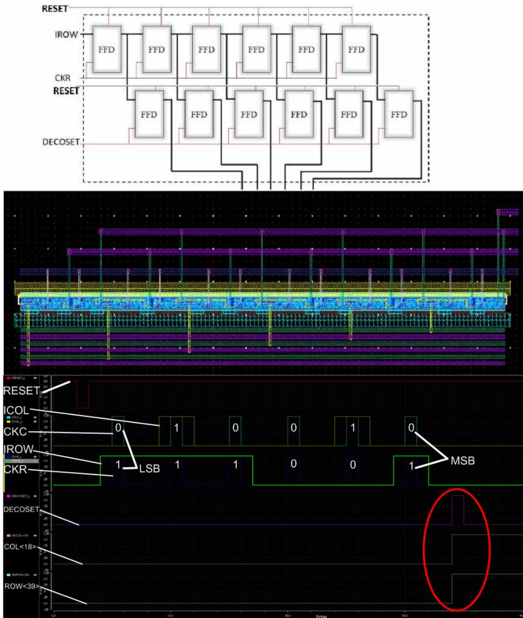
Figura 4-7. Esquemático, layout y ejemplo de funcionamiento de los registros de desplazamiento de la lógica de control para la selección de celdas en KIPT.
