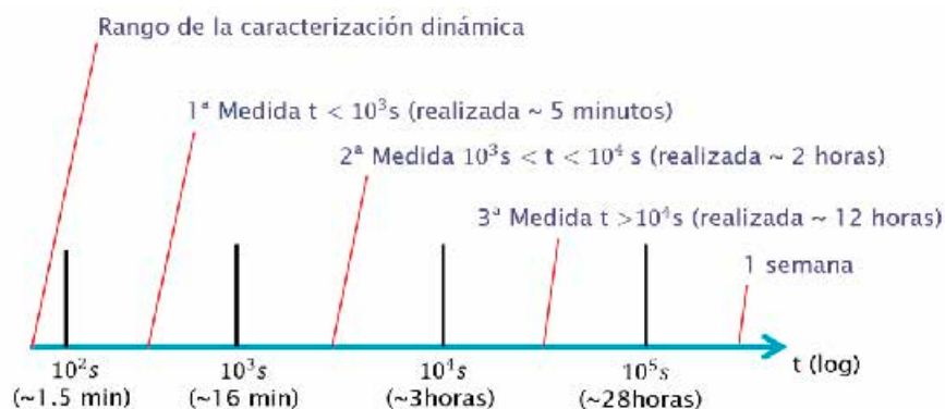
Figura 5-13. Esquema de medidas para observar cuanto tiempo persisten los fenómenos de recuperación.
