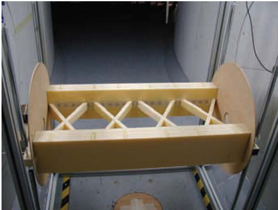
Figura 59. Modelo seccional del arco, sin deflectores, montado en túnel de viento.
