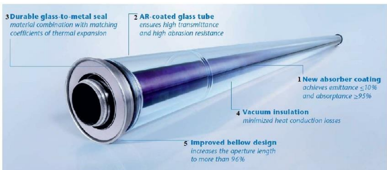
Figura 79. Componentes del tubo absorbedor de Schott.
