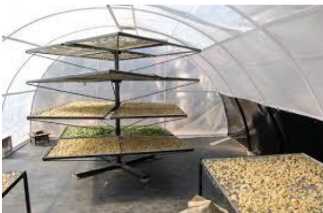
Figura 9. Secador solar industria alimentaria.
