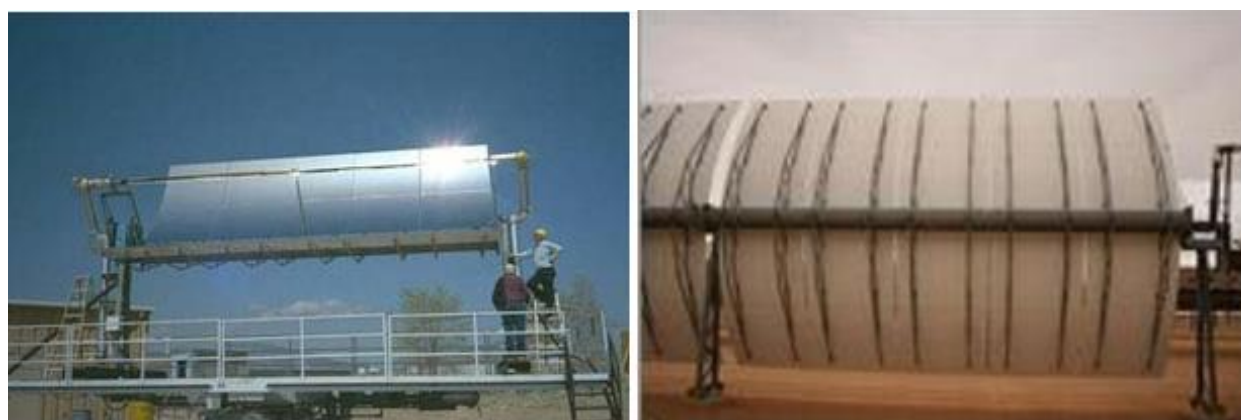
Figura 71. Parte frontal y estructura del colector LS-2.
