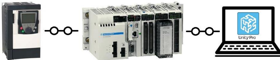
Figura 8. Conexión entre Altivar 71 con PLC Modicon M340 y el software Unity Pro XL ejecutado en una PC
