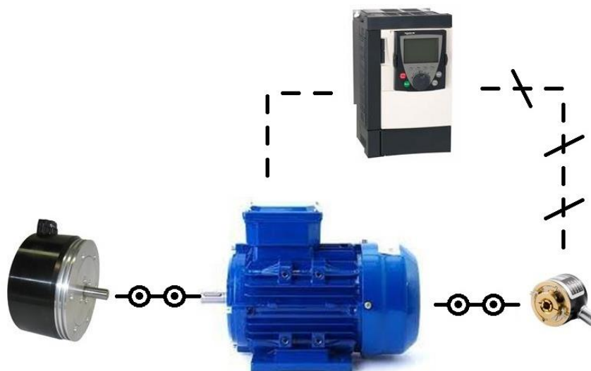
Figura 7. Conexionado entre bancada con frenos de histéresis y codificador, con Altivar 71.
