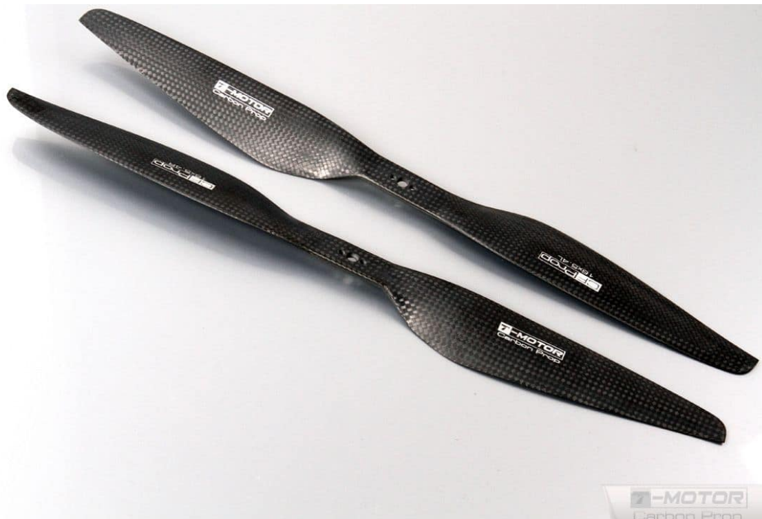
Figura 2.3 Hélices de fibra de carbono 16x5.4". Fuente: [5].
