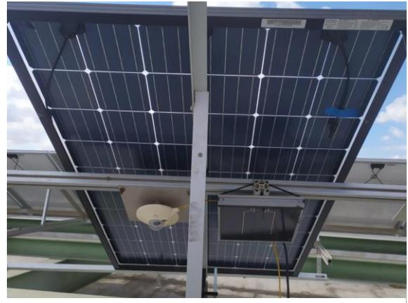
Figura 5-7. Detalle del piranómetro trasero en la nueva situación, más centrado en el eje del panel, pero con el problema de la estructura
