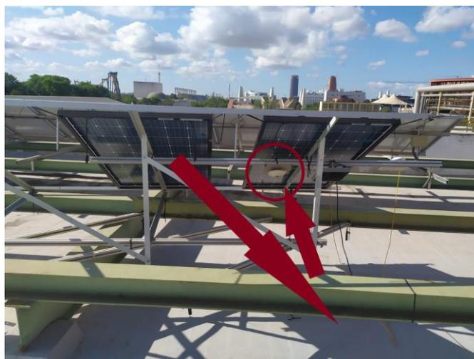
Figura 5-6. Sombreado del panel sobre el suelo debajo del piranómetro trasero
