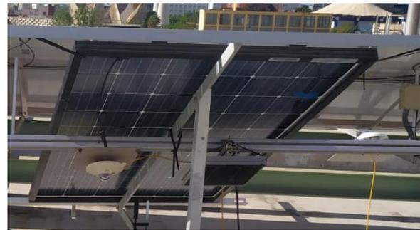
Figura 5-5. Detalle del piranómetro trasero
