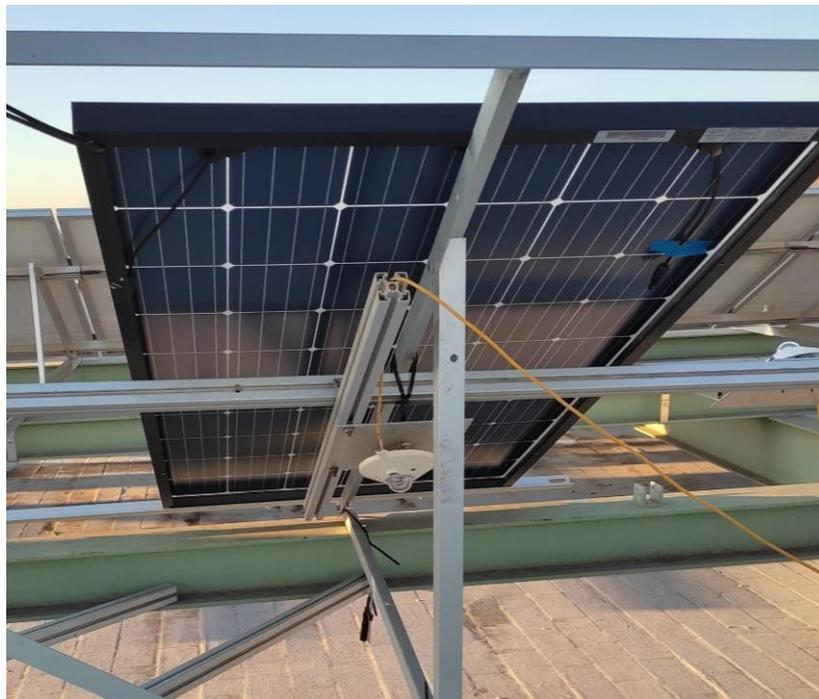
Figura 5-9. Detalle del piranómetro trasero centrado en el eje de simetría del panel
