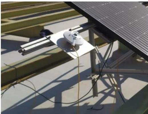
Figura 5-4. Detalle del piranómetro delantero
