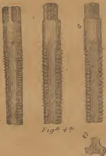
bles se conseguiría hacerlo penetrar en la materia. En cuanto á la profundidad de estas canales, debe ser tal, que sin ser excesiva para que el macho no pierda resistencia, sea, sin embargo, la suficiente para que los cortes se hallen en las mejores condiciones.
