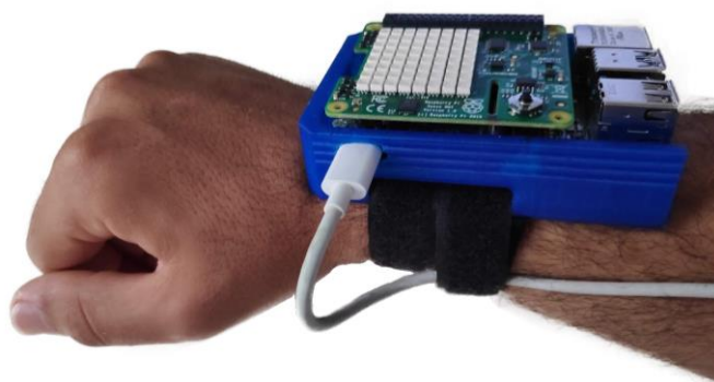
Figura 4. Raspberry Pi + Sense Hat + Plataforma.
