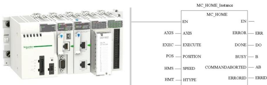
Figura 3-5: PLC M340 (izquierda). Ejemplo de función (LD) de la Librería *Motion control* para el ajuste del Modo Home (derecha).
