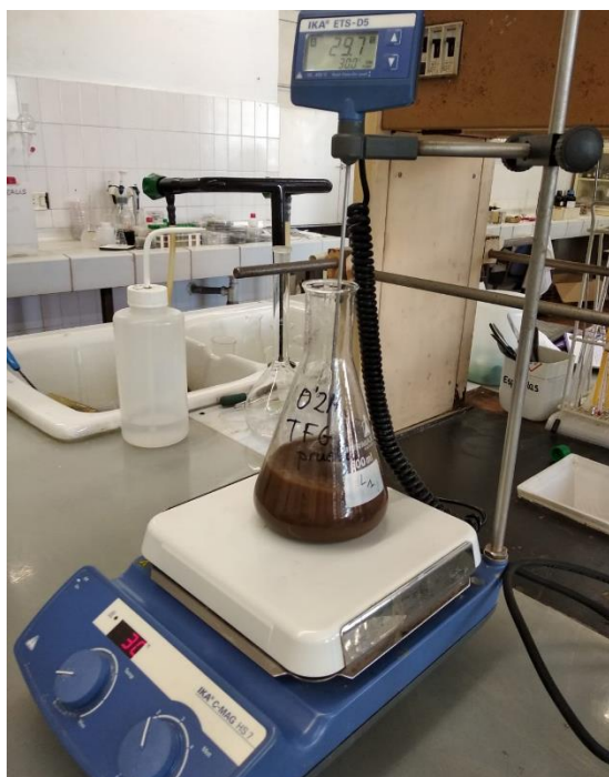
Figura 8. Disolución colocada en agitador magnético para estudio cinético a 30°C.
