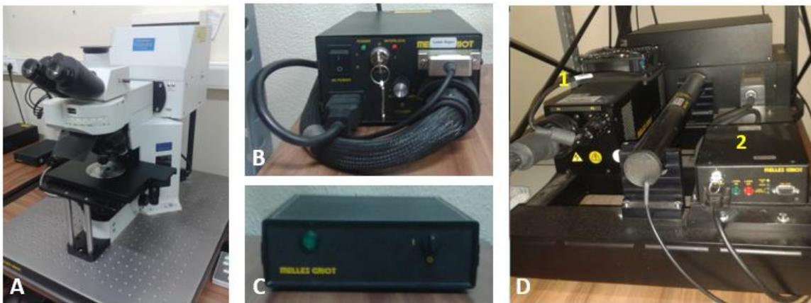
**Figura 25. Componentes del microscopio láser confocal Olympus FV1000. A.** Microscopio motorizado de transmisión directa Olympus FV1000. **B.** Sistema láser de Argón. **C.** Sistema láser de Helio-Neón rojo. **D.** Sistema láser de Helio-Neón verde (1) y sistema de ventilación de los láseres (2).
