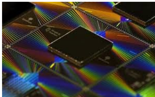
Figura 5.1: Procesador Sycamore utilizado por Google para alcanzar la supremacía cuántica. Imagen tomada de [28].
