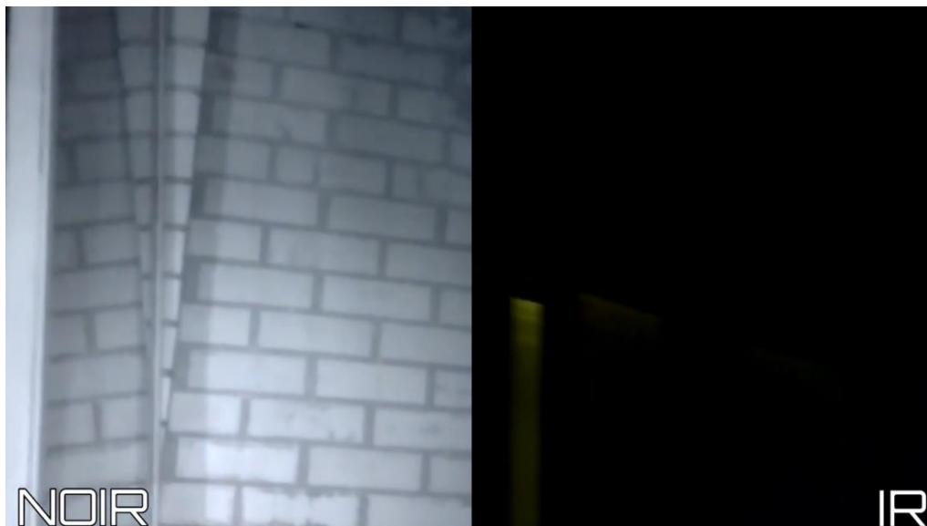
Figura 3-14: Pi Cam v2.1 (derecha) y Pi Cam NoIR v2.1 (izquierda). Imagen en condiciones de visibilidad nula, con iluminación de LEDs infrarrojos.
