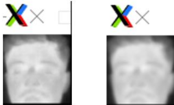
Figura 5-4: ROI sin aplicar filtro de Gauss (izquierda); ROI aplicando filtro de Gauss (derecha).
