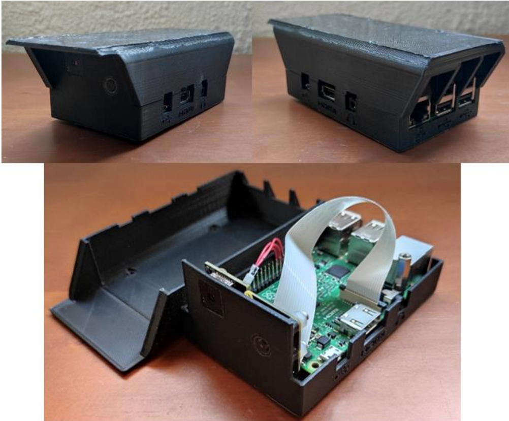
Figura 6-3: Vista de pieza real de plataforma de cámaras y Raspberry Pi 3 B.
