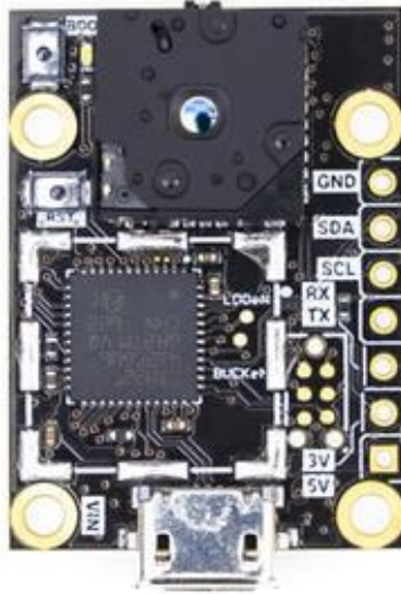
Figura 3-11: PureThermal 2 junto con sensor Lepton 3.5 by FLIR.
