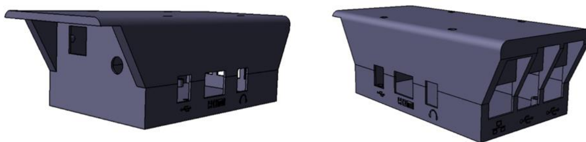
Figura 6-1: Vista de plataforma de cámaras y Raspberry Pi 3B.
