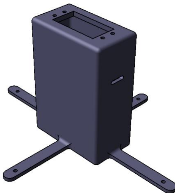
Figura 6-4: Soporte base y anclaje del motor 1.
