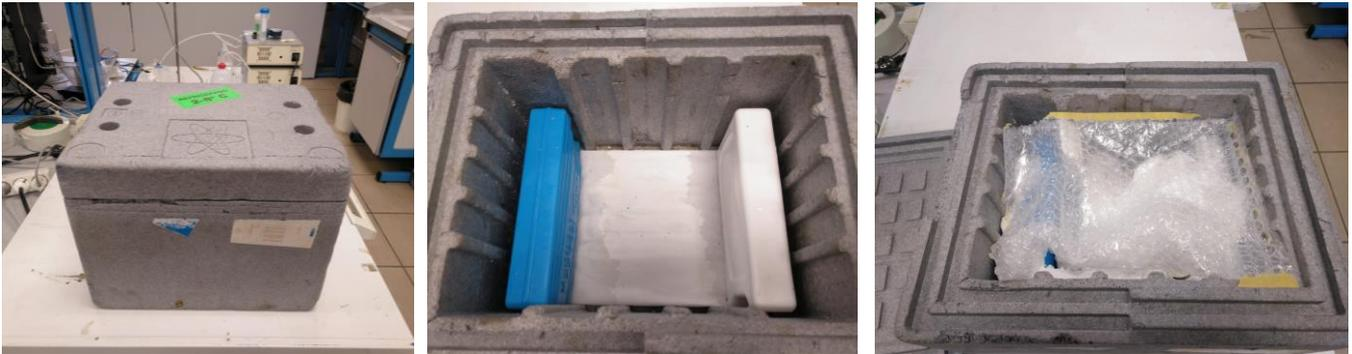
5 – Izquierda: caja de porexán cerrada. Centro: interior de la caja con bloques que mantienen el frío. Derecha: interior aislado con plásticos y otros materiales para garantizar una velocidad de enfriamiento inferior a  $1^{\circ}\text{C}/\text{min}$
