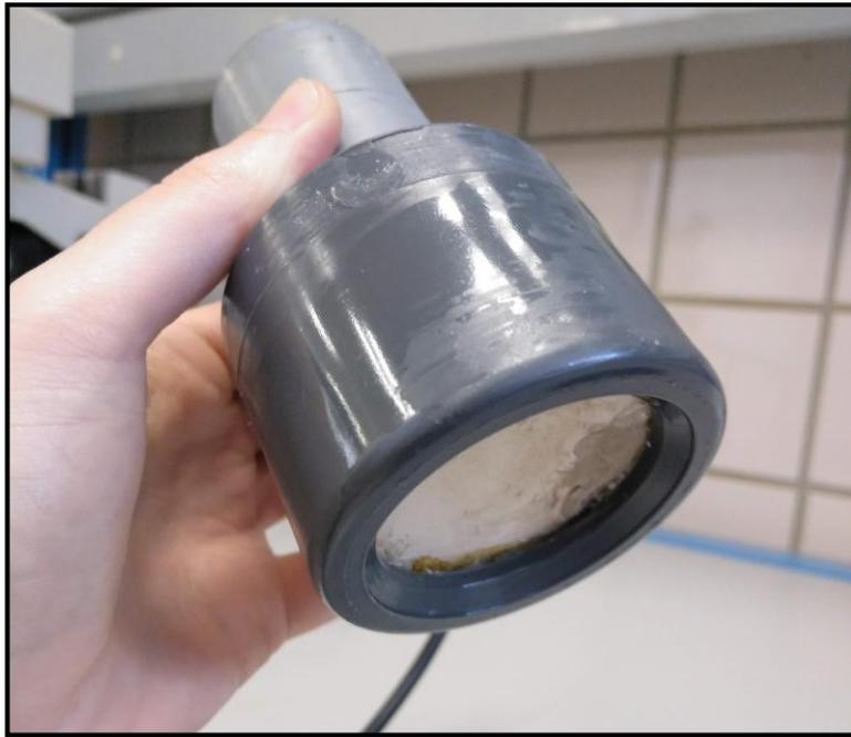
8 - Imagen del transductor parabólico hecho de cerámica piezoeléctrica
