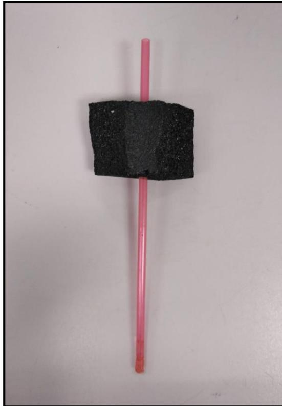
28 – Pajuela insertada en un trozo de espuma de polietileno que funciona a modo de flotador
