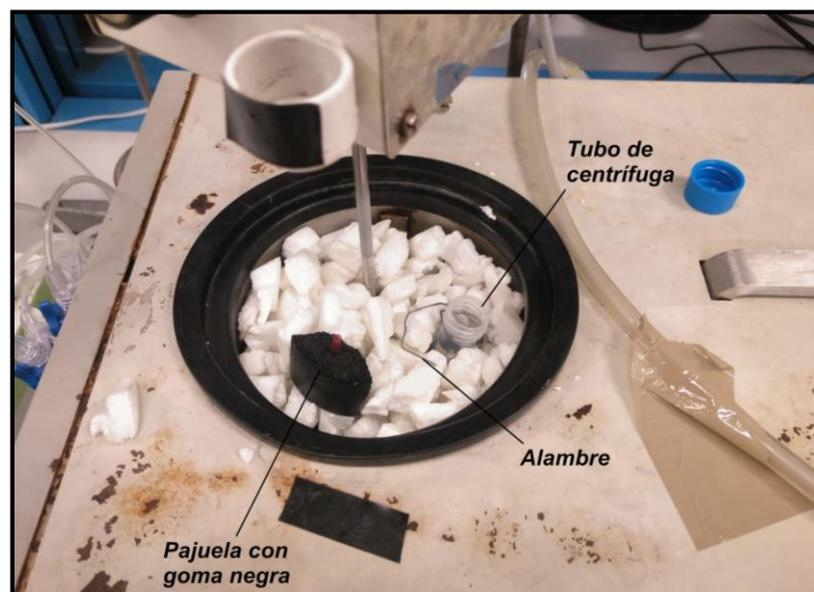
30 - Detalle del baño de etanol del Biocool en el que se enfrían las muestras
