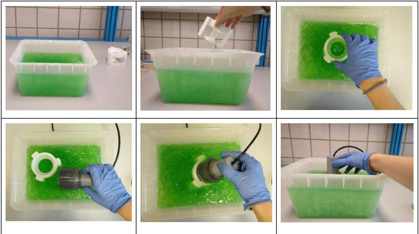
22 - Proceso de colocación de soporte y el transductor en el baño de etilenglicol para disparar a la placa (en las imágenes no aparece la placa colocada, pero debería estar en la parte baja del soporte como se ha indicado anteriormente).
