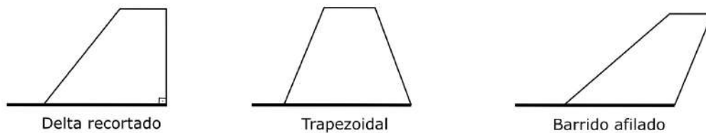
Figura 3.37 Geometría típica de aletas de cohetes.
