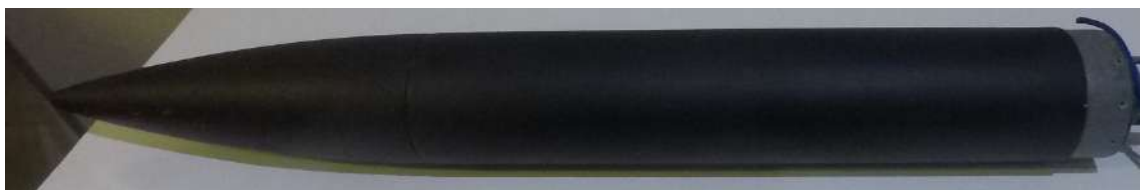
Figura 5.92 Sección del paracaídas de NAOS.
