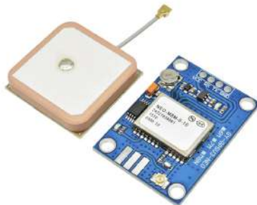
Figura 4.26 PinOut del módulo GPS NEO-M8N y antena cerámica.
