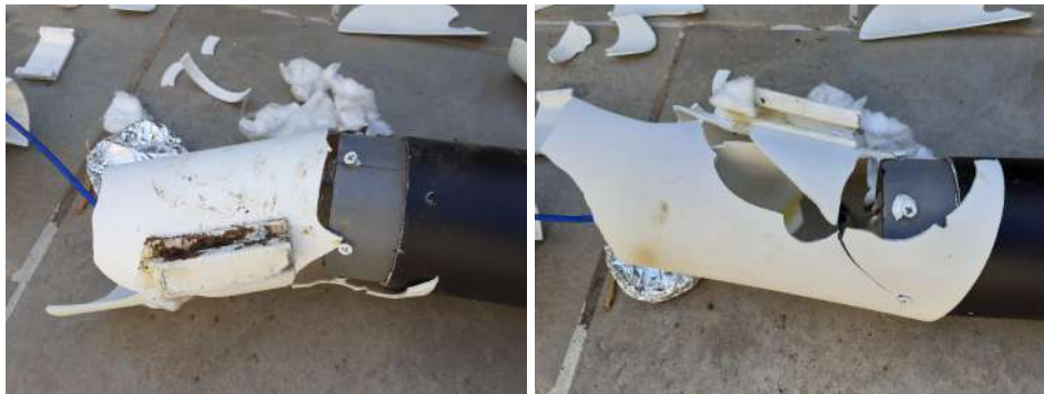
Figura 6.83 Modo de rotura del acoplamiento entre secciones.
