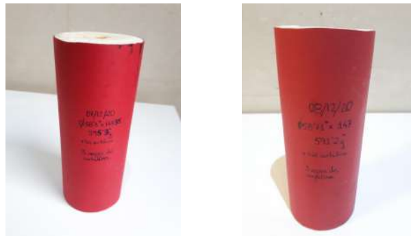
Figura 6.28 Carga de 2 granos largos de propulsante para el ensayo en banco de Diciembre del 2020
