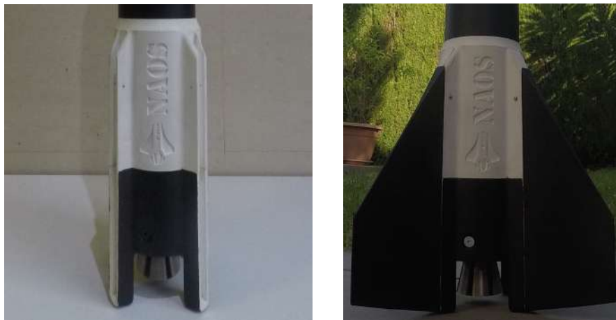
Figura 5.88 Aletas de NAOS con capa de pintura.
