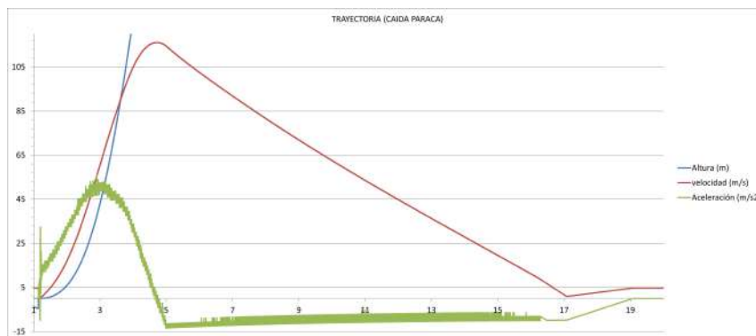
Figura 6.20 Trayectoria con apertura de paracaídas del ensayo en banco de Septiembre 2020 (Zoom).
