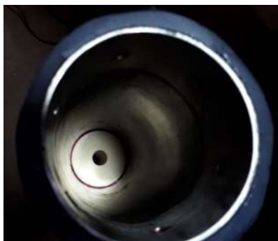
Figura 6.29 Posición de los granos de propulsante en el ensayo en banco de Diciembre del 2020 .
