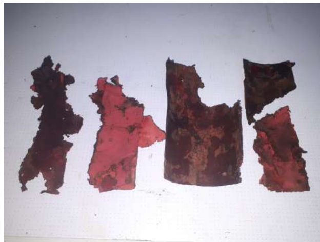
Figura 6.35 Restos de la inhibición tras el ensayo de Diciembre de 2020.
