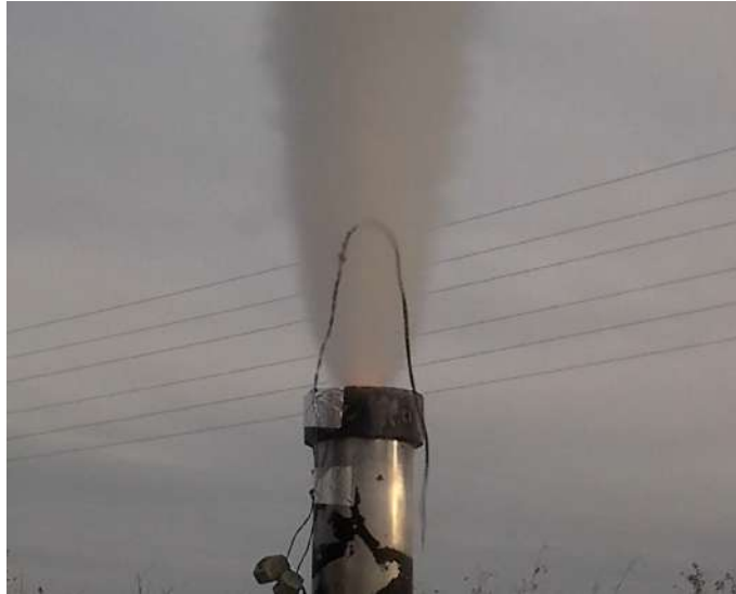
Figura 6.34 Fotograma de eyección de ignitor del ensayo de Diciembre de 2020, previo a la explosión.
