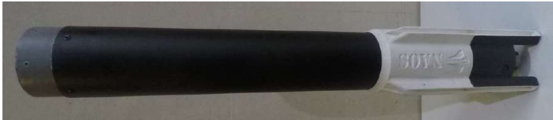
Figura 5.90 Sección del motor cohete de NAOS.
