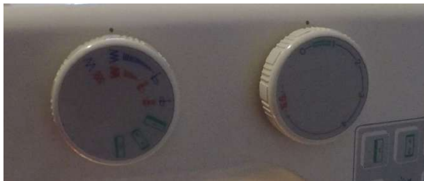
Figura 5.74 Parámetros de la máquina de coser para puntada en zigzag.
