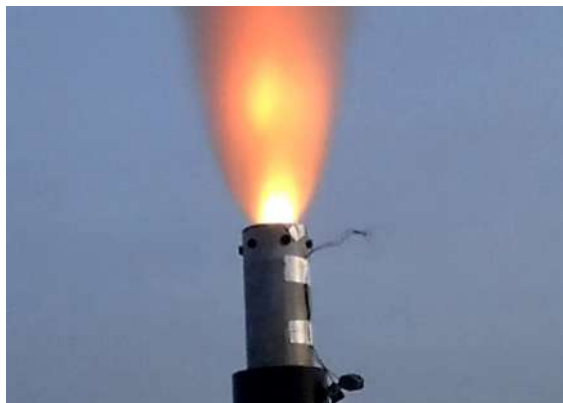
Figura 3.29 Tobera de NAOS Sobre-Expansionada (comportamiento real).
