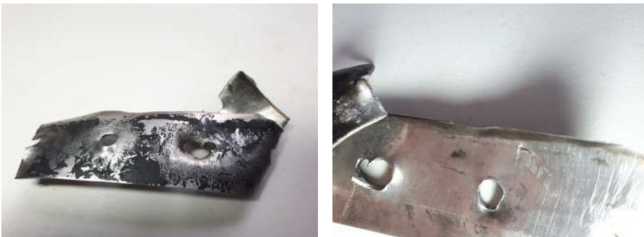
Figura 6.37 Aspecto del borde de unión tobera y carcasa tras el ensayo de Diciembre de 2020.
