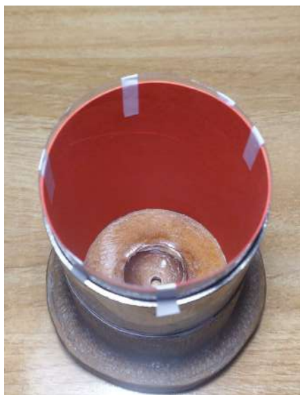
Figura 5.15 Cartulina de inhibición del grano integrada en el molde.
