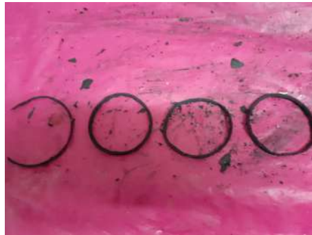
Figura 6.60 Estado de las juntas tóricas de separación de granos de propulsante tras el ensayo de Abril de 2021.
