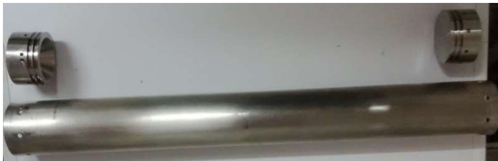
Figura 5.1 Motor cohete de NAOS. Carcasa, cierre posterior y tobera sobre expansionada.
