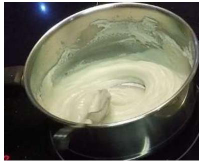
Figura 5.22 Proceso de cocinado, propulsante fundido (80-90°C).
