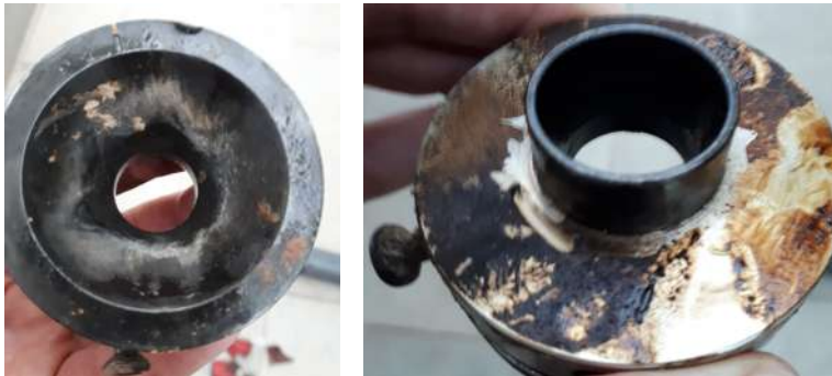
Figura 6.36 Aspecto de la tobera tras el ensayo de Diciembre de 2020.
