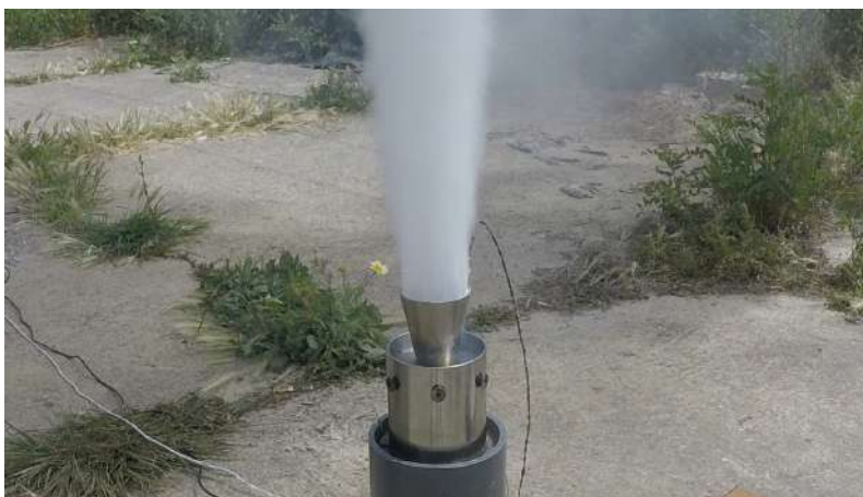
Figura 6.54 Fotograma del ensayo de Abril de 2021 en el instante de Tobera Adaptada.
