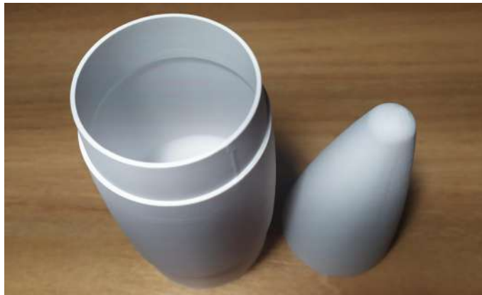
Figura 5.81 Impresión 3D por partes de ojiva de NAOS.
