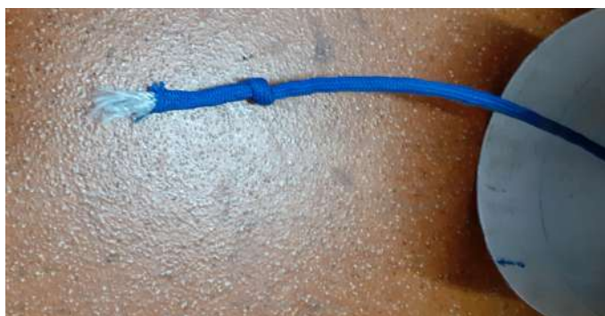
Figura 6.81 Rotura a cizalladura de la cuerda del paracaídas.
