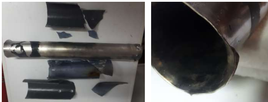
Figura 6.39 Aspecto de la carcasa tras el ensayo de Diciembre de 2020.
