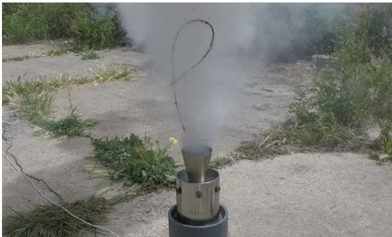
Figura 6.53 Fotograma del ensayo de Abril de 2021 en el instante de eyección del ignitor.
