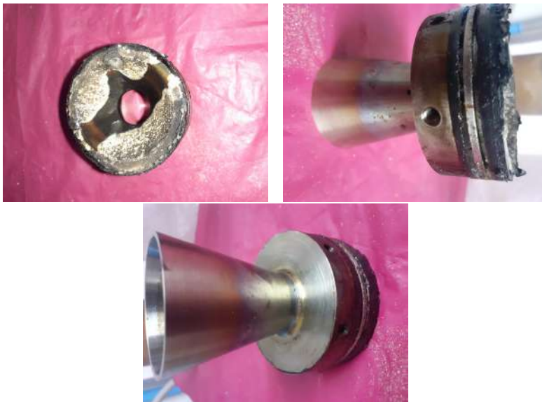
Figura 6.58 Aspecto de la tobera tras el ensayo de Abril de 2021.
