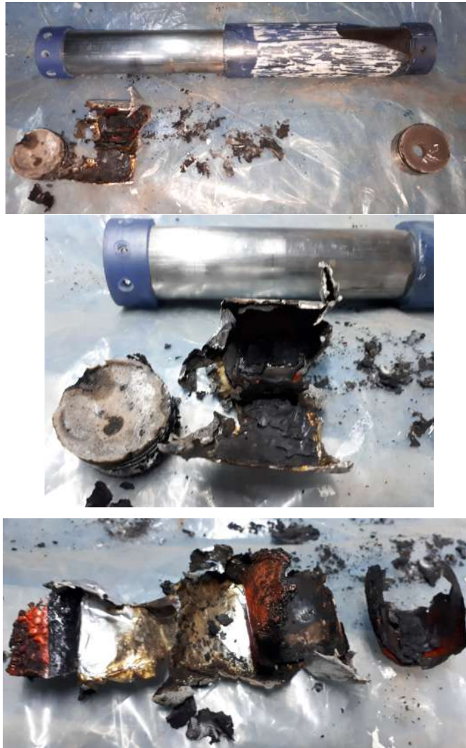
Figura 6.15 Restos de inhibición tras la prueba en banco de Diciembre de 2018.
