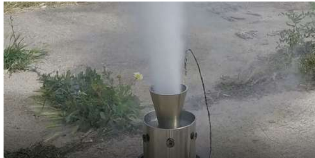
Figura 3.20 Tobera de NAOS Sub-Expansionada (comportamiento real, ensayo en banco de Cohe- teros).
