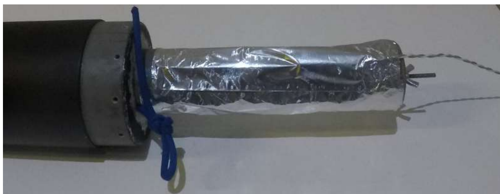
Figura 5.61 Sistema de Liberación y Recuperación armado ON, recubierto con cinta adhesiva de aluminio.
