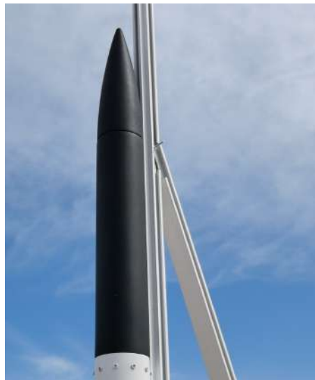
Figura 5.101 Vista del anclaje de la barra oblicua rigidizadora de la rampa de lanzamiento.
