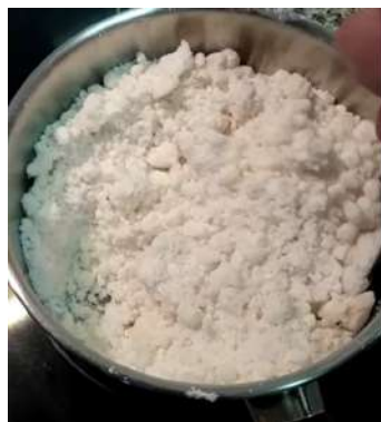
Figura 5.20 Proceso de cocinado, propulsante granulado (60°C).
