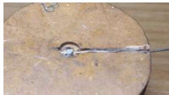
Figura 5.25 Anclaje entre vástago y base del molde.
