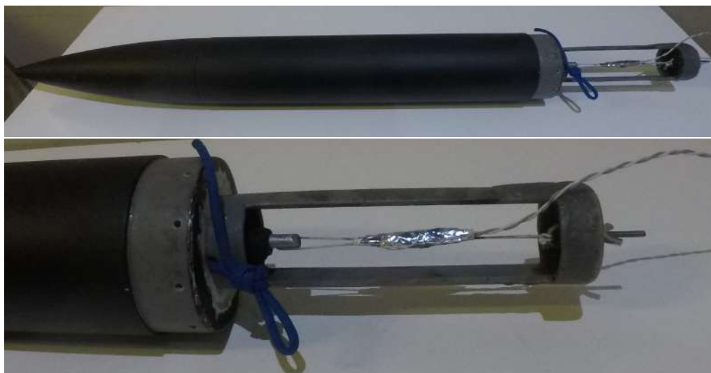
Figura 5.60 Sistema de Liberación y Recuperación armado ON.
