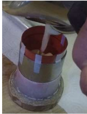
Figura 5.24 Vertido de propulsante en estado líquido en el molde.
