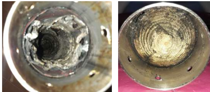
Figura 6.61 Aspecto de la carcasa tras el ensayo de Abril de 2021.
