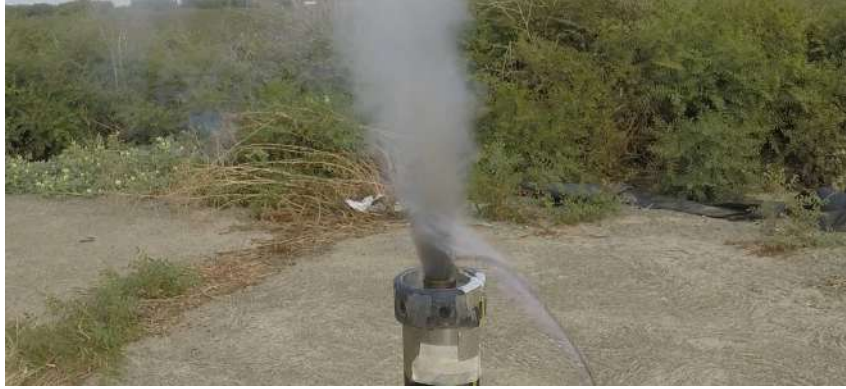
Figura 6.23 Fotograma de eyección de ignitor del ensayo de Septiembre de 2020.
