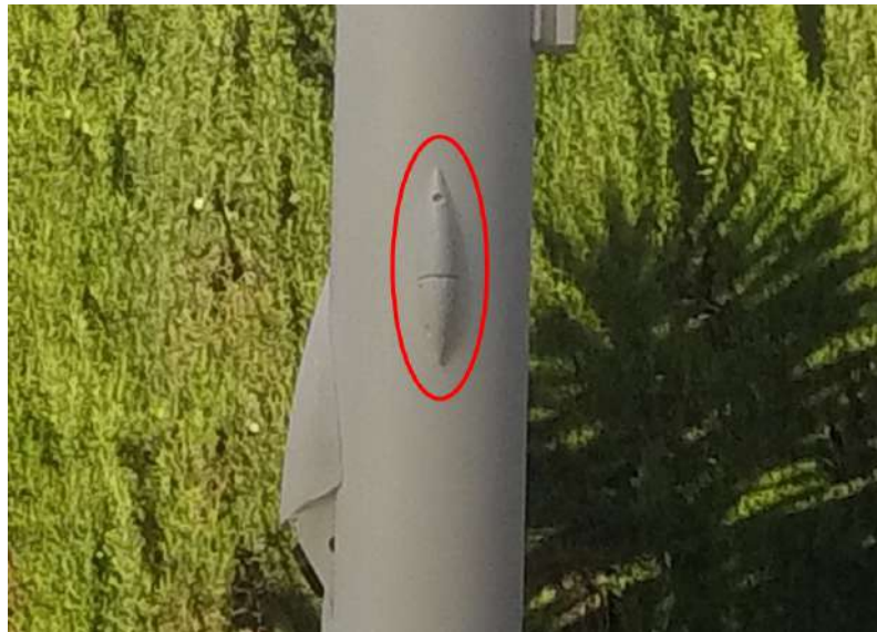
Figura 4.16 Imagen de la geometría del conector del Trigger en la carcasa de NAOS.
