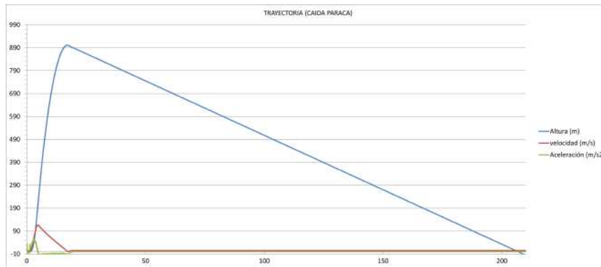
Figura 6.19 Trayectoria con apertura de paracaídas del ensayo en banco de Septiembre 2020.
