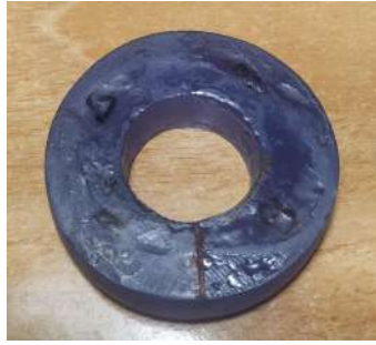
Figura 5.8 Tapa móvil del molde de propulsante.
