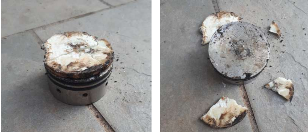
Figura 6.25 Residuos en el cierre posterior tras la prueba en banco de Septiembre de 2020.
