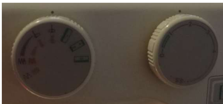
Figura 5.72 Parámetros de la máquina de coser para puntada recta.
