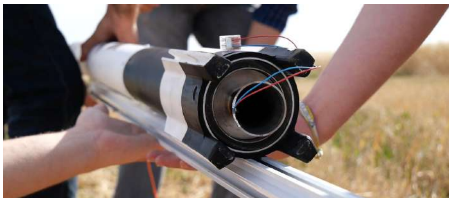
Figura 6.71 Anclaje de cohete NAOS a rampa de lanzamiento.
