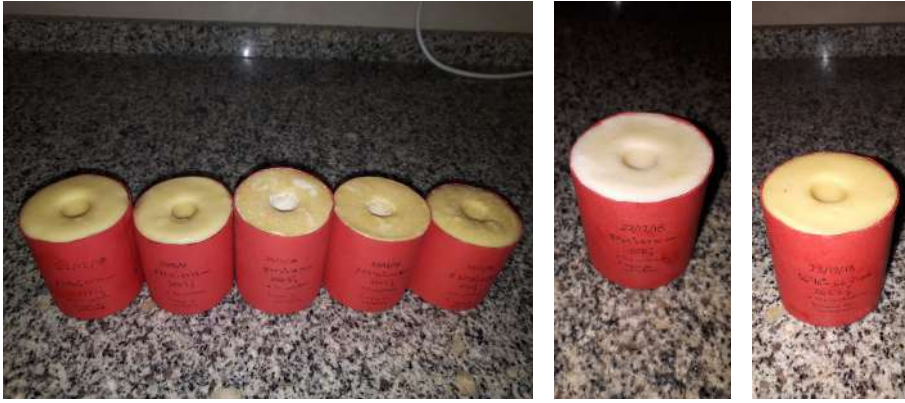
Figura 6.5 Carga de 7 granos de propulsante para el ensayo en banco de Diciembre del 2018 .
