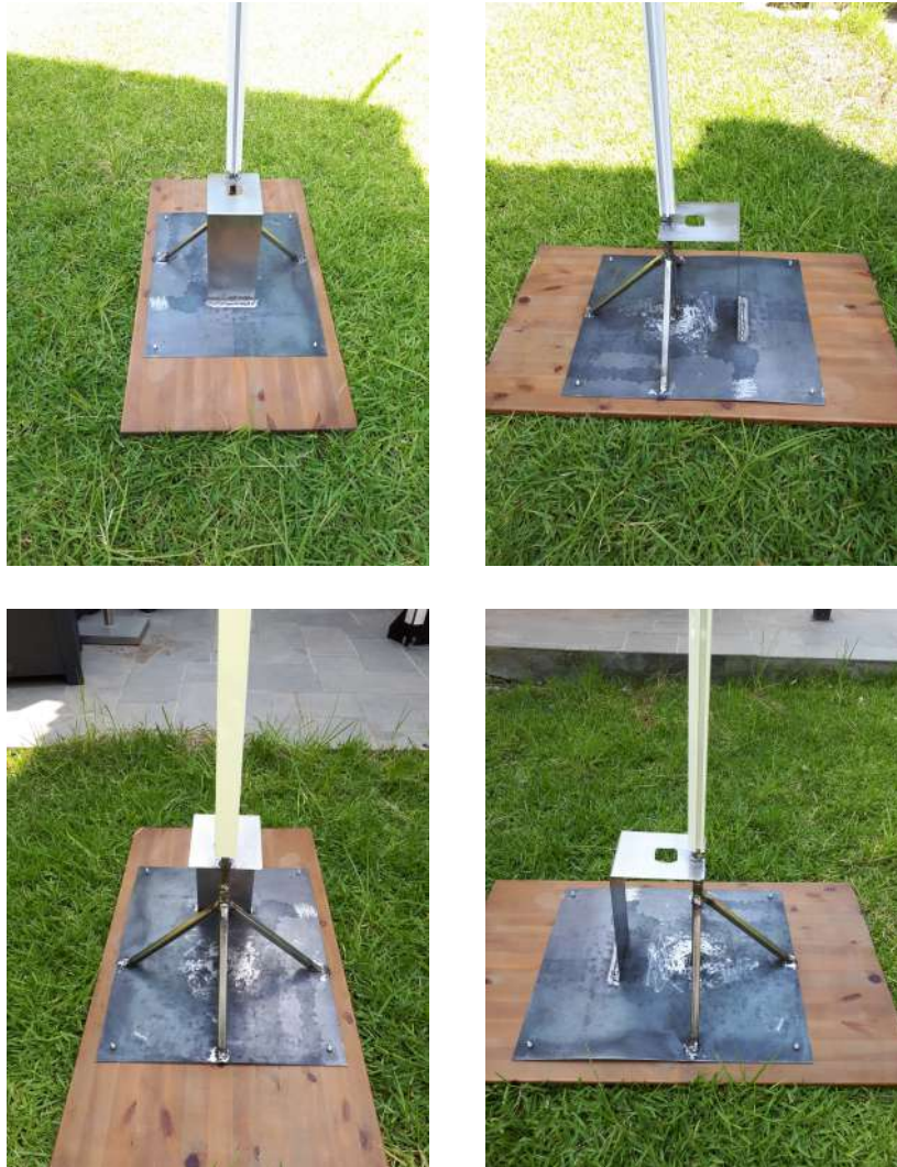
Figura 5.99 Rampa de lanzamiento parte inferior sin pintar.
