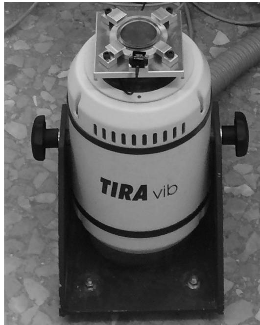
Figura 5: Fotografía del vibrador utilizado para imponer las oscilaciones en el recipiente. A él se encuentra anclado el propio recipiente y el acelerómetro utilizado.
