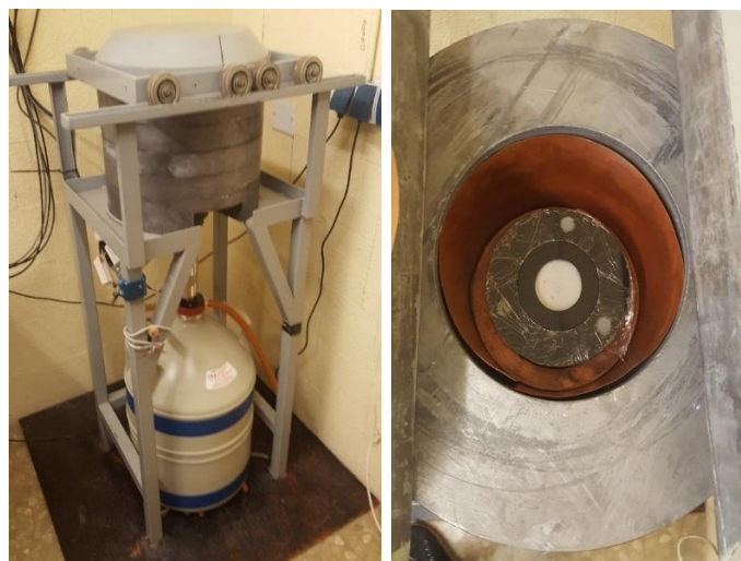
Figura 9. En la imagen de la izquierda observamos el detector con el tanque de nitrógeno. En la imagen de la derecha observamos el blindaje de plomo y la ventana de Berilio del detector.
