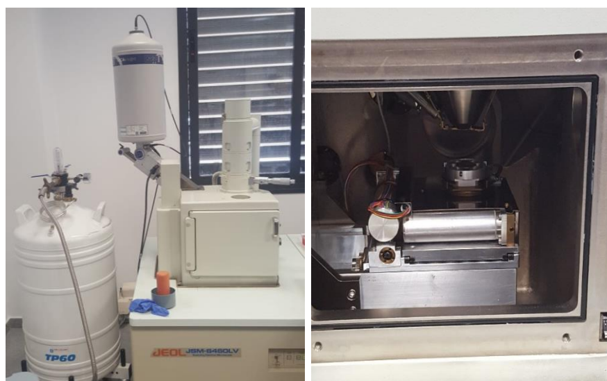
Figura 16. A la izquierda, imagen del MEB al completo con el sistema de refrigeración. A la derecha, el interior del MEB donde vemos el cañón de electrones.
