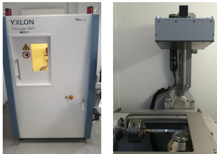
Figura 11. En la imagen de la izquierda observamos el equipo al completo. En la imagen de la derecha, el tubo de rayos X abajo, el soporte rotatorio con la muestra y el detector plano en la parte superior.
