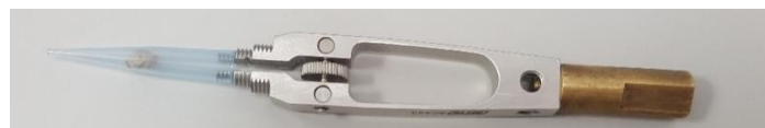
Figura 22. Sistema con el que colocamos la partícula en el TAC para que pueda rotar.
