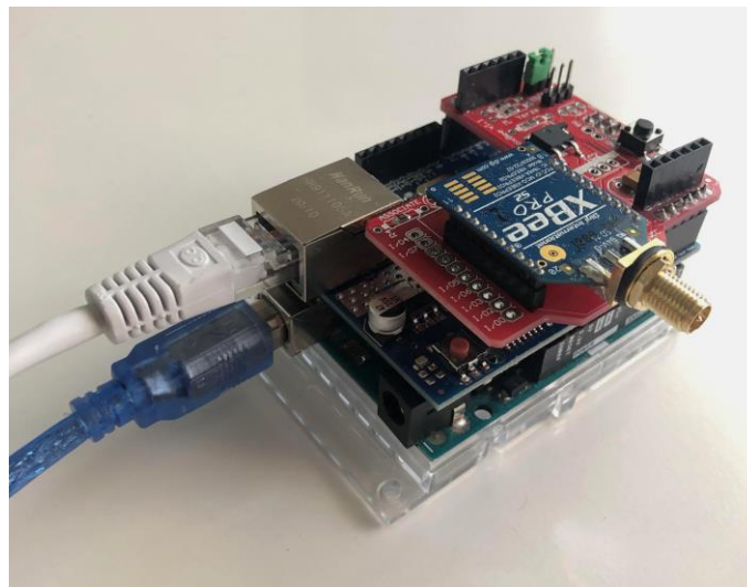
Figura 12. Shields XBee y Ethernet conectadas simultáneamente al Arduino UNO.
