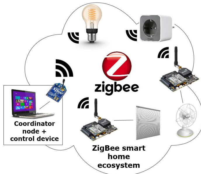
Figura 30. PC como nodo coordinador y dispositivo controlador del ecosistema ZigBee.
