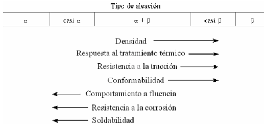
Figura 11 Evolución de los valores de distintas propiedades en función del tipo de aleación
