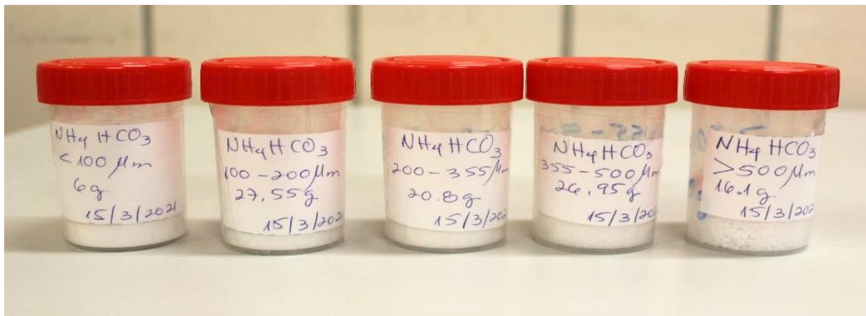
Figura 20 NH_4HCO_3 clasificado según el diámetro de partículas
