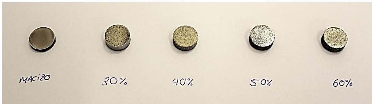
Figura 39 Sustratos fabricados con tamaño de espaciador 100-200 \mu\text{m} a distintos porcentajes de porosidad
