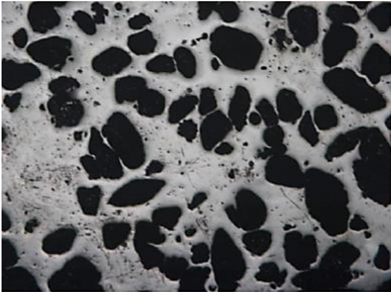
Figura 45 Micrografía sustrato tamaño de poro 100-200 \mu\text{m} 40% de porosidad [70]
