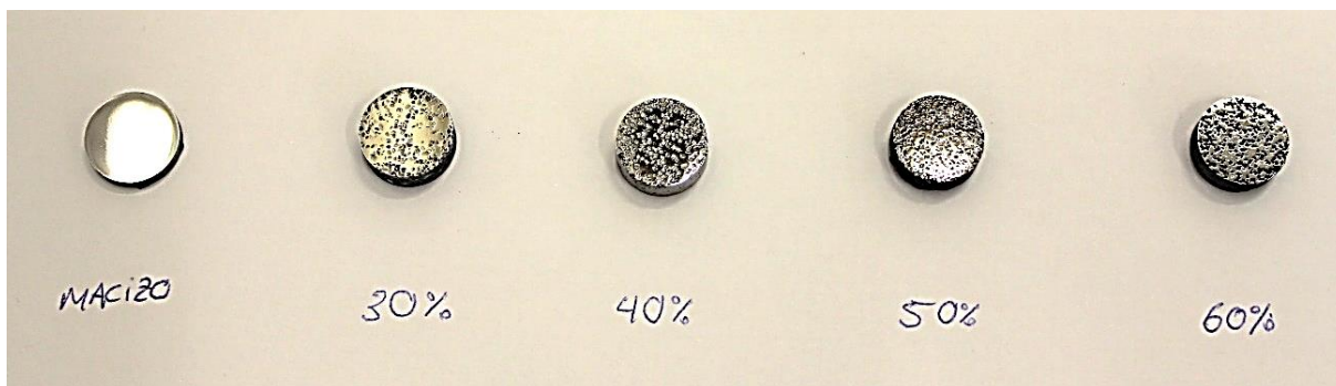
Figura 41 Sustratos fabricados con tamaño de espaciador 355-500 \mu\text{m} a distintos porcentajes de porosidad
