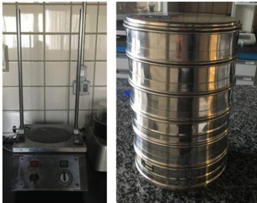
Figura 24: (a) Plato vibratorio para proceso de tamizado, (b) tamices empleados
