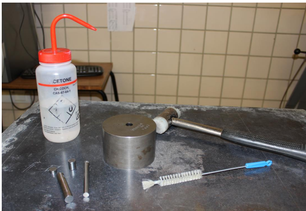
Figura 29 Matriz, punzones y elementos para limpieza de los mismos
