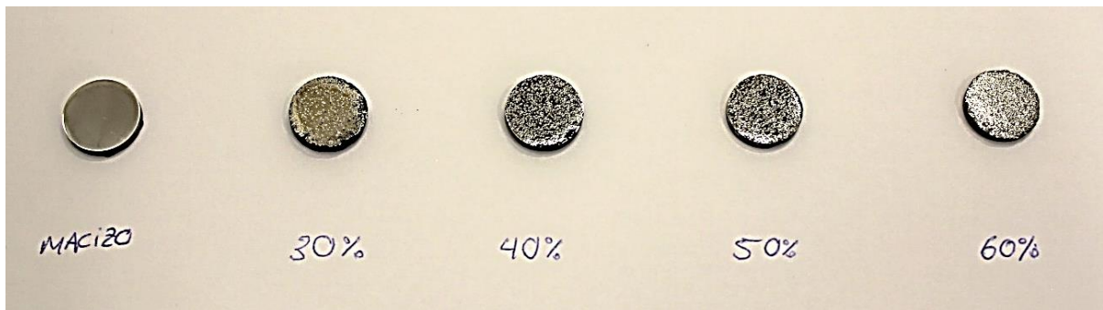
Figura 40 Sustratos fabricados con tamaño de espaciador 200-355 \mu\text{m} a distintos porcentajes de porosidad
