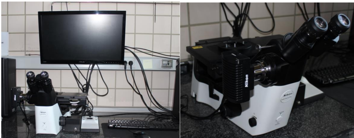
Figura 37 Microscopio óptico empleado Nikon Epiphot con cámara Jenoptik Progress C3 acoplada
