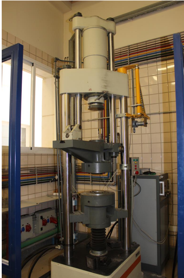
Figura 30 Prensa Suzpecar 600 kN
