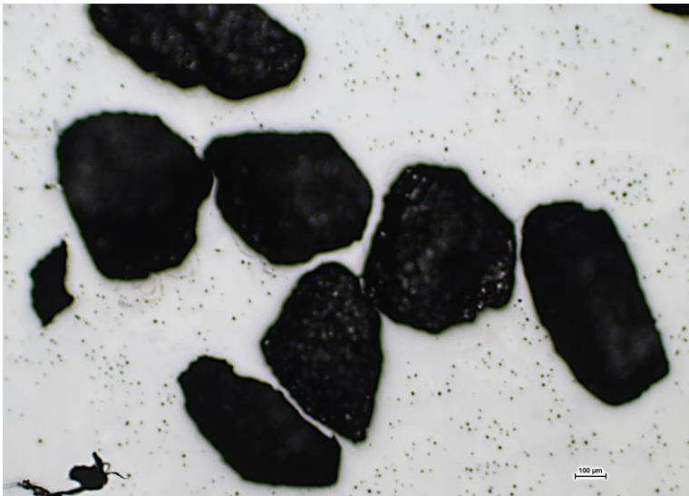
Figura 46 Micrografía sustrato tamaño de poro 355-500 \mu\text{m} 30% de porosidad
