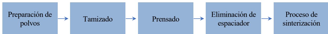
Figura 22 Diagrama de flujo del proceso a seguir para la fabricación de los sustratos
