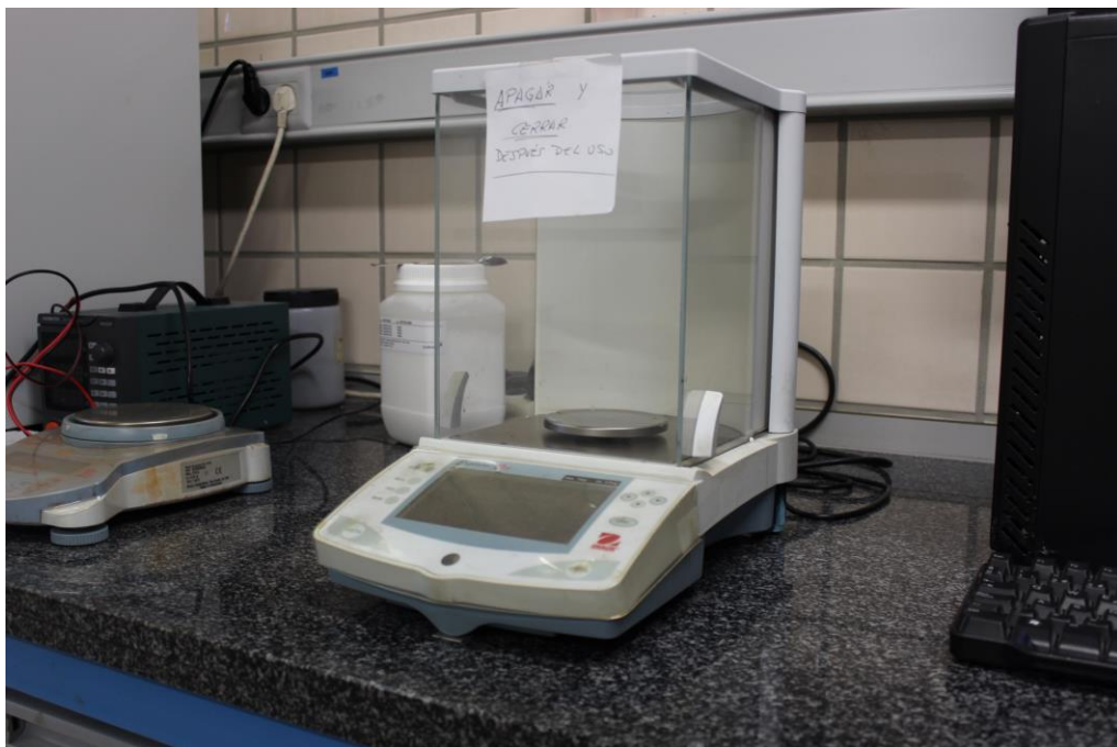
Figura 26 Báscula empleada para el pesaje de los materiales
