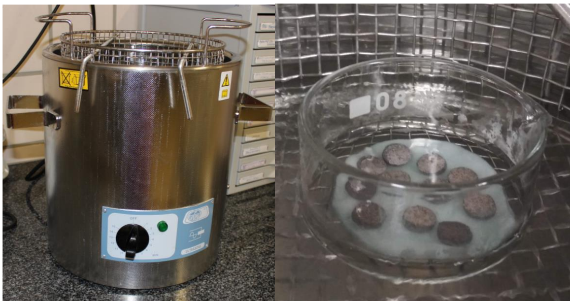
Figura 34 Proceso de limpiado con ultrasonidos
