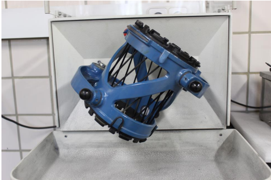
Figura 23 Mezcladora WAB Machiney, Túrbulas T2C
