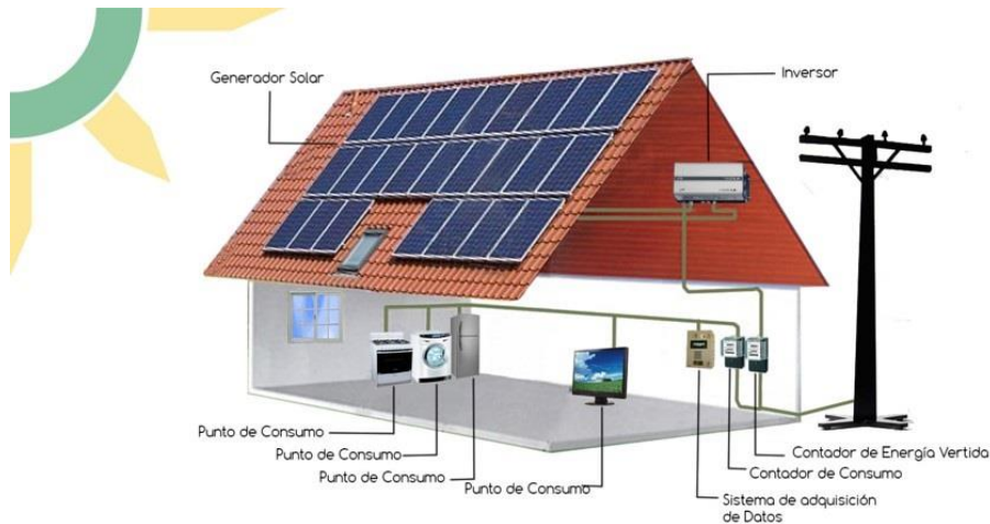
Ilustración 7. Instalación típica de autoconsumo actual según RD 244/2019. (APEME, 2021)
