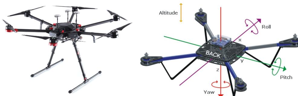
**Figura 4.1** Ejemplo de multirotor (DJI Matrice 600 Pro) y de los grados de libertad de un multirotor (Montgomery, 2014).
