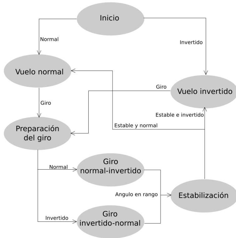
Figura 3-2: Diagrama de estados de la operación de giro libre en bucle cerrado
