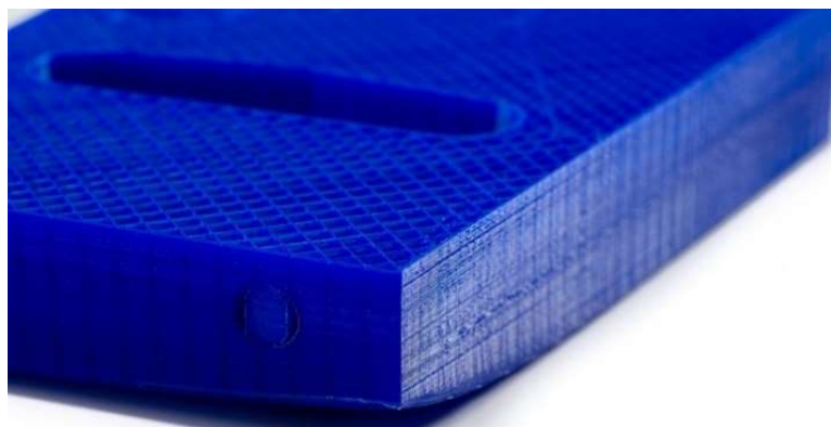
Figura 3.39. Pieza con warping (25)
