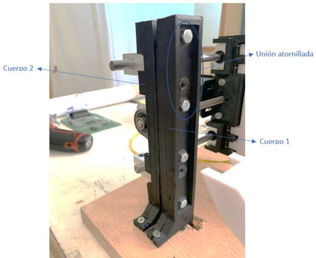
Figura 3.45. Unión abisagrada fija
