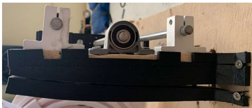
Figura 3.41. Bisagra fija deformada por warping
