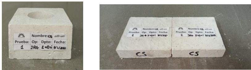
Figura 42. Probeta para ataque químico (Izquierda). Probetas para abrasión (Derecha). CS.
