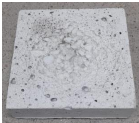
Figura 78. Estado de la probeta de material FOSF1 tras ensayo de resistencia a la abrasión.
