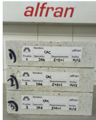
Figura 39. Probetas de CAC para ensayos térmicos y mecánico
