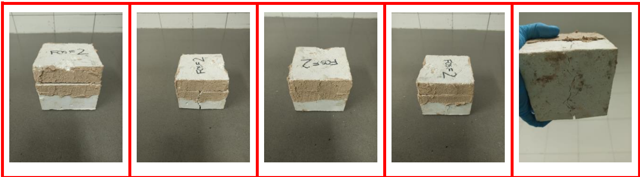
Figura 86. Aspecto externo de las probetas de ataque químico con álcalis del material FOSF 2.
