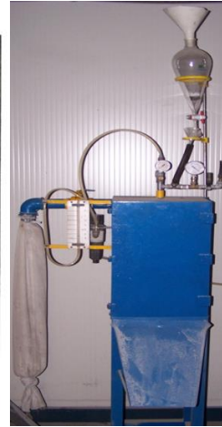
Figura 38. Esquema y fotografía del equipo de determinación de la resistencia a abrasión.
