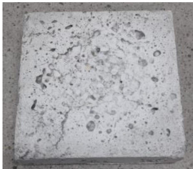
Figura 88. Estado de la probeta de material FOSF2 tras ensayo de resistencia a la abrasión.
