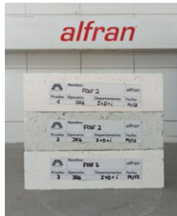
Figura 46. Probetas de FOSF 2 para ensayos térmicos y mecánicos.
