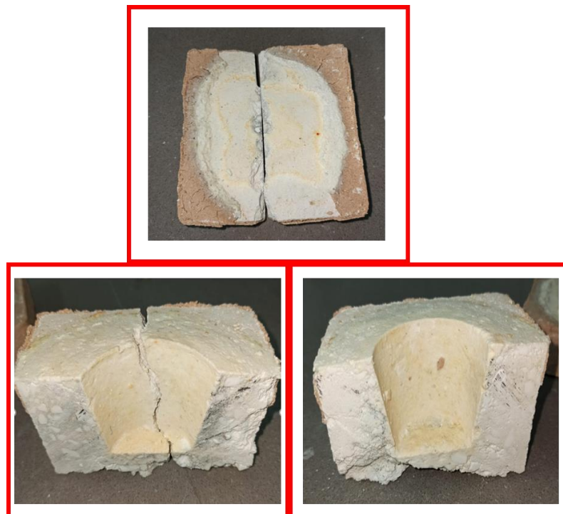
Figura 77. Aspecto interno de las probetas de ataque químico con álcalis del material FOSF 1.
