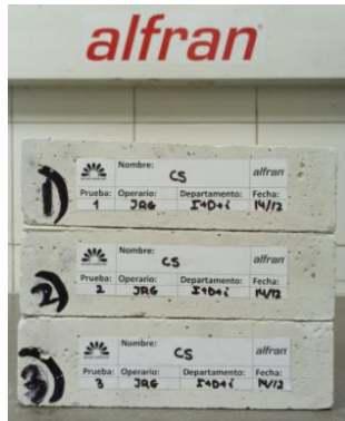
Figura 41. Probetas de CS para ensayos térmicos y mecánicos.
