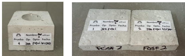
Figura 47. Probeta para ataque químico (Izquierda). Probetas para abrasión (Derecha). FOSF 2.
