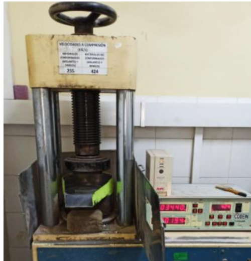
Figura 33. Instrumento usado por alfran para medir la resistencia a la compresión en frío.
