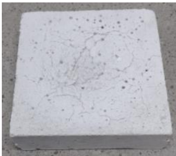
Figura 68. Estado de la probeta de material CS tras ensayo de resistencia a la abrasión.
