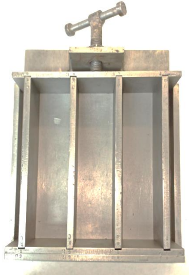
Figura 29. Moldes con medidas 230x65x55 cm.
