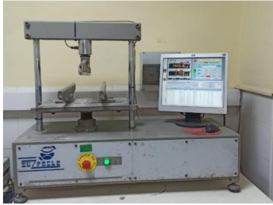
Figura 32. Instrumento usado por alfran para medir la resistencia a la flexión en frío
