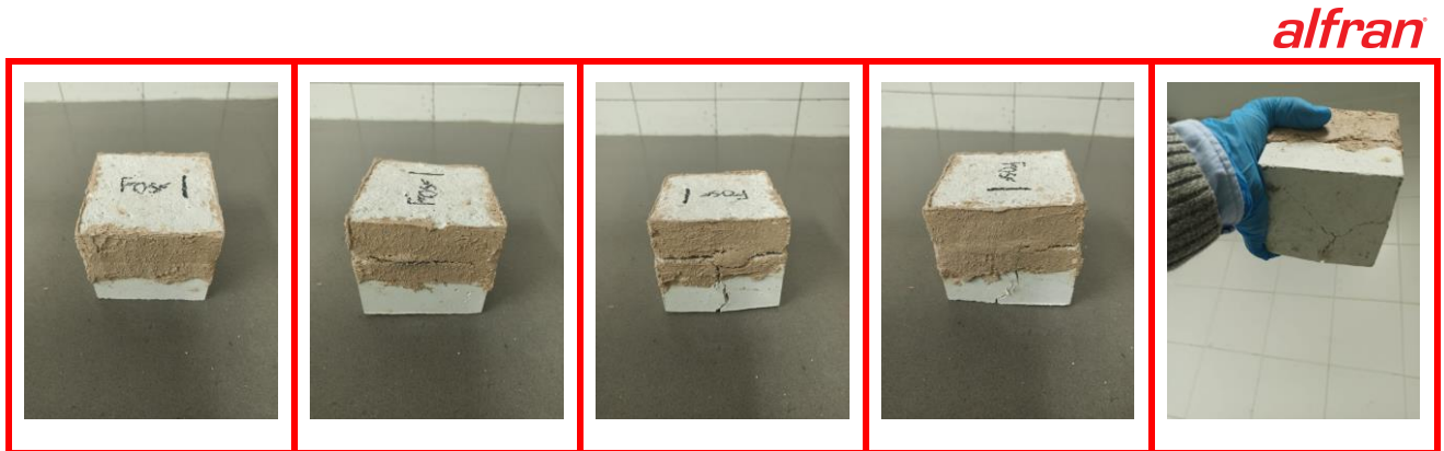
Figura 76. Aspecto externo de las probetas de ataque químico con álcalis del material FOSF 1.
