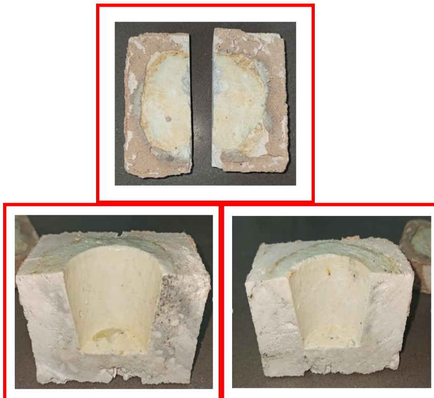
Figura 87. Aspecto interno de las probetas de ataque químico con álcalis del material FOSF 2.
