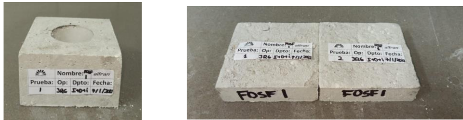
Figura 45. Probeta para ataque químico (Izquierda). Probetas para abrasión (Derecha). FOSF 1.
