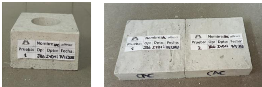
Figura 40. Probeta para ataque químico (Izquierda). Probetas para abrasión (Derecha). CAC.
