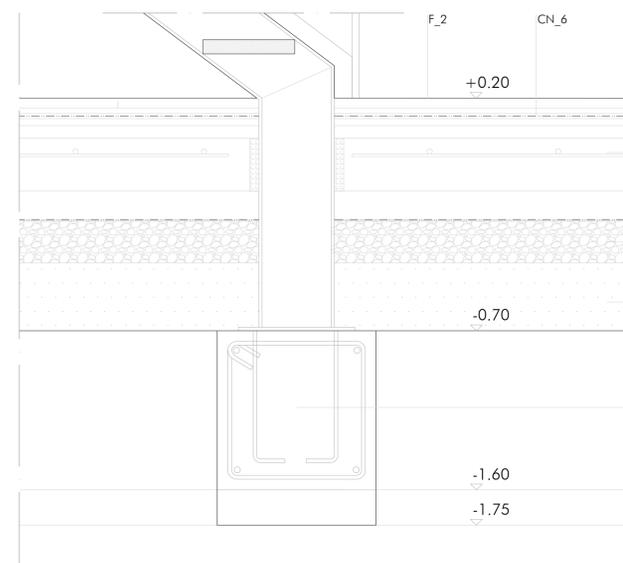
DETALLE A-A' ARRANQUE ESCALERA METÁLICA
