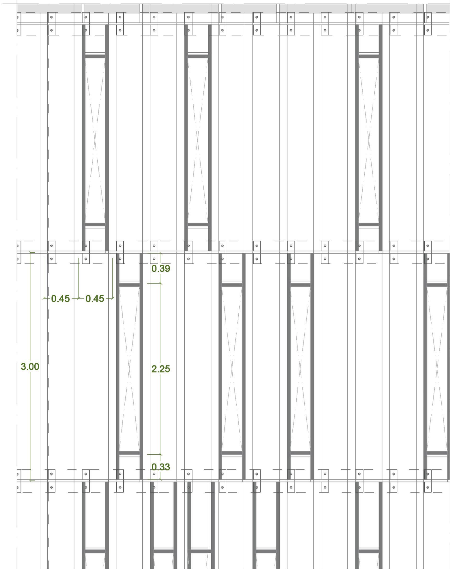
1. MONTANTES VERTICALES AQUAPANEL - PREMARCO HUECOS E 1/30
