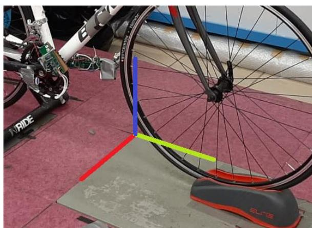
Figura 2-4. Origen de coordenadas global del experimento (X rojo, Y verde, Z azul).
