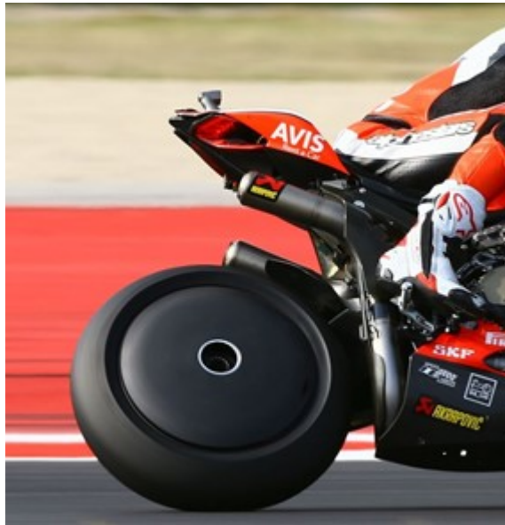
Figura 6.7 Llanta trasera lenticular.
