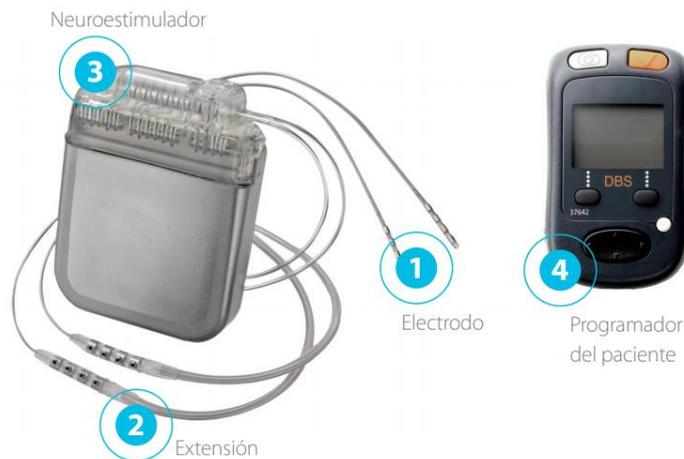
Figura 3-8. Componentes de un sistema ECP [12].
