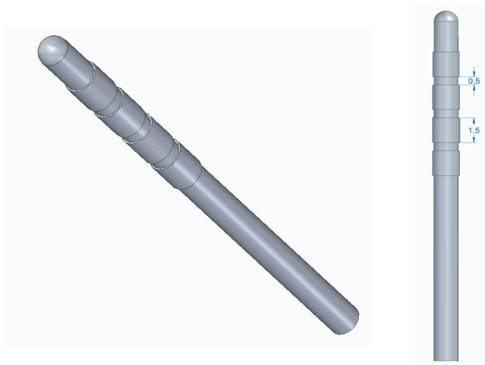
Figura 5-1. Modelo de implante cuadripolar modelado en Solid Edge
