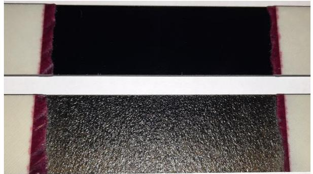
Figura 2. Acabados superficiales obtenidos con contra-molde (superior) y sin contra-molde (inferior) en la cara superior de los laminados.
