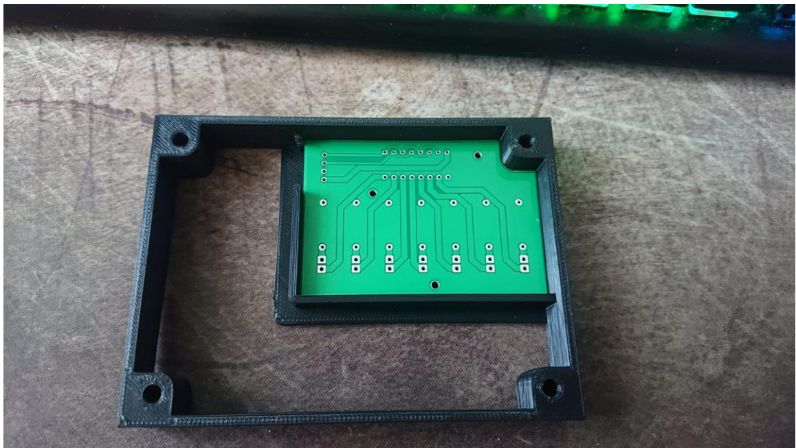
Ilustración 2-3: Muestra de encaje de PCB
