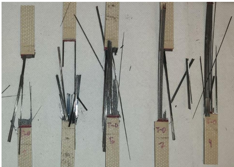
Figura 9: Probetas de 0° a tracción tras ser ensayadas.
