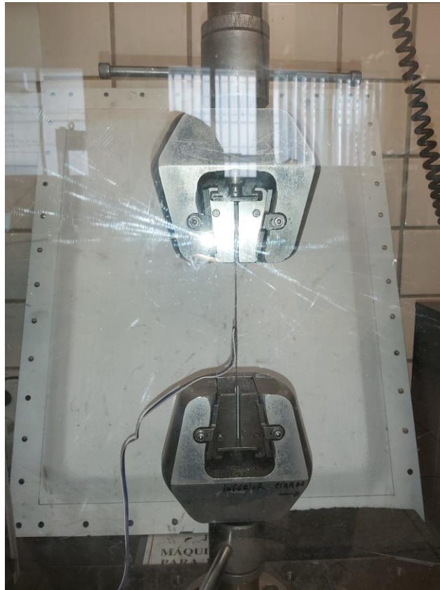
Figura 8: Configuración empleado en la caracterización de probetas a 0°.
