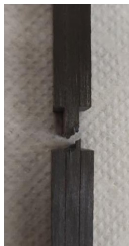
Figura 11: Rotura resultante en la probeta de 0° de compresión.
