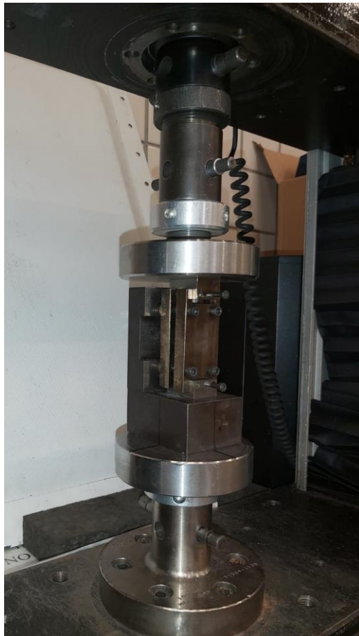
Figura 12: Configuración utilizada en los ensayos a compresión.
