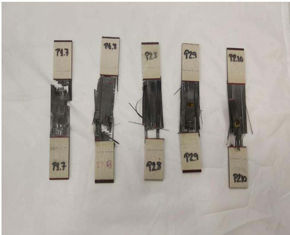
Figura 16: Probetas ensayadas en la caracterización del laminado [0 4 /90 0 4]
