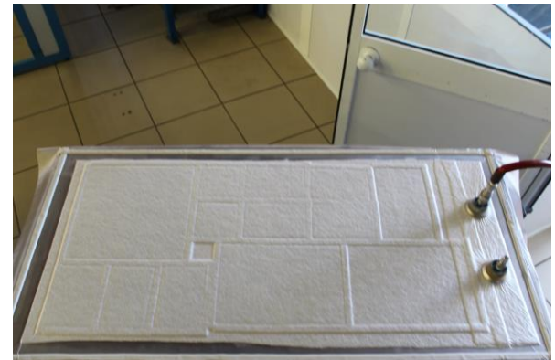
Figura 6: Proceso de fabricación de la bolsa de vacío. 1: Plancha debidamente lijada; 2.1: Distribución de laminados; 2.2: Colocación lamina de teflón; 3: Colocación tiras de corcho; 4: Sellado de la bolsa de vacío.
