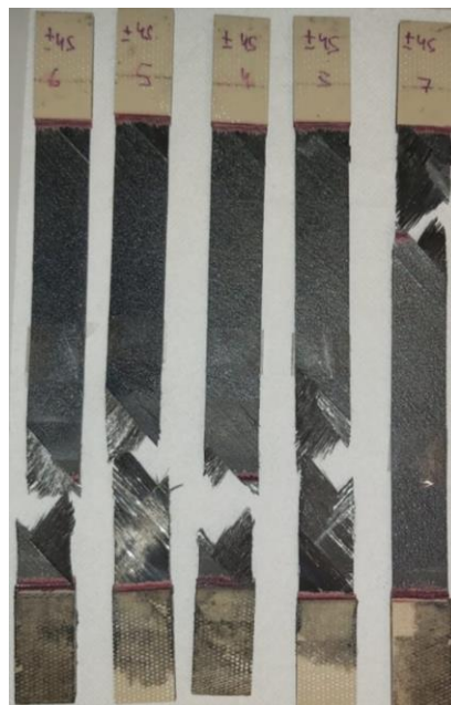
Figura 14: Probetas de \pm 45^\circ tras ser ensayadas.
