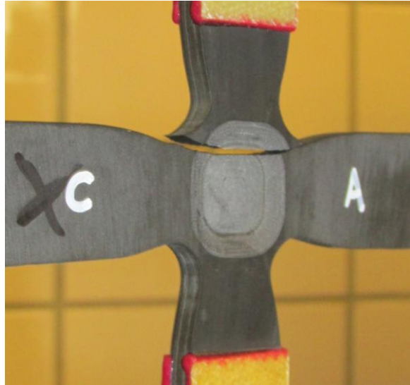
Figura 4.3.4. Zona de rotura de la probeta 1.
