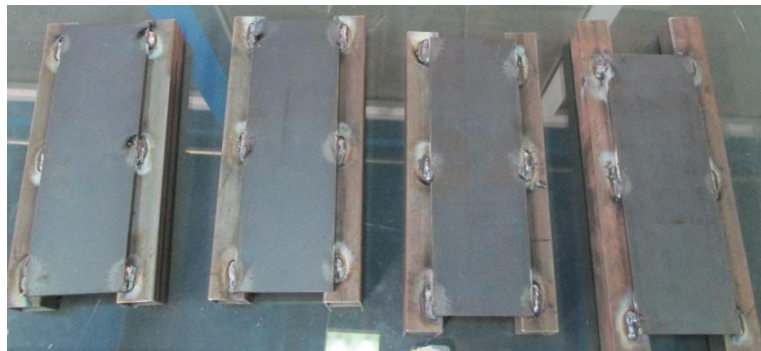
Figura 3.1.27. Elementos auxiliares del nuevo sistema de agarre.
