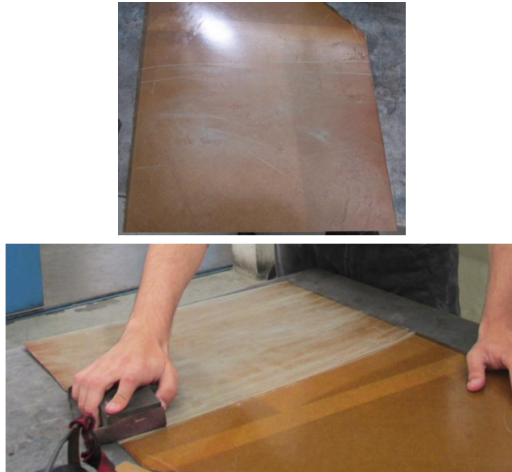
Figura 3.2.10. Lijado del panel de fibra de vidrio.
