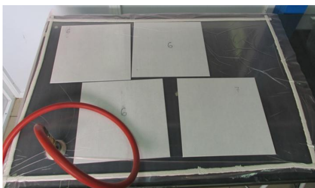
Figura 3.1.10. Ciclo de precompactado de laminados de 6 láminas.
