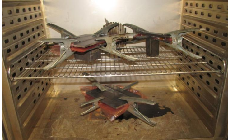
Figura 3.1.55. Montaje para el curado del adhesivo para probetas con tacos en ambos ejes.
