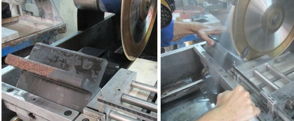
Figura 3.1.37. Corte transversal de la cruceta en “rebanadas”.
