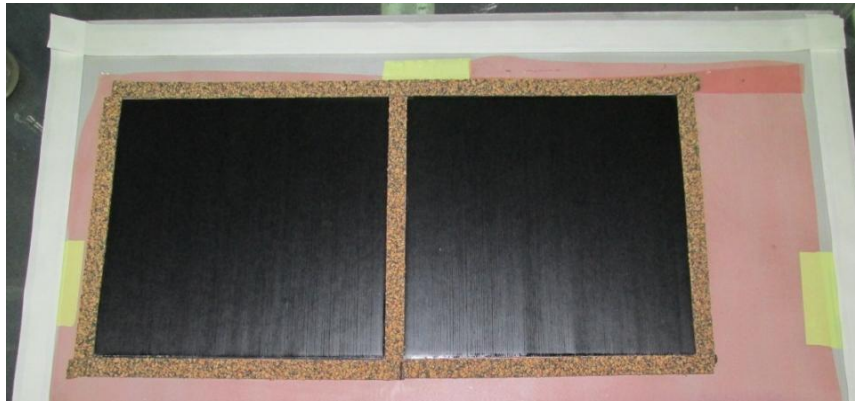
Figura 3.2.5. Montaje para el curado de los laminados de 200x190 mm.
