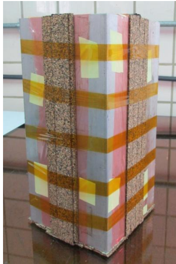
Figura 3.1.23. Colocación de cinta de alta temperatura al bloque.
