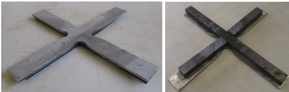
Figura 3.1.39. Modelo metálico usado como plantilla para el recantado.
