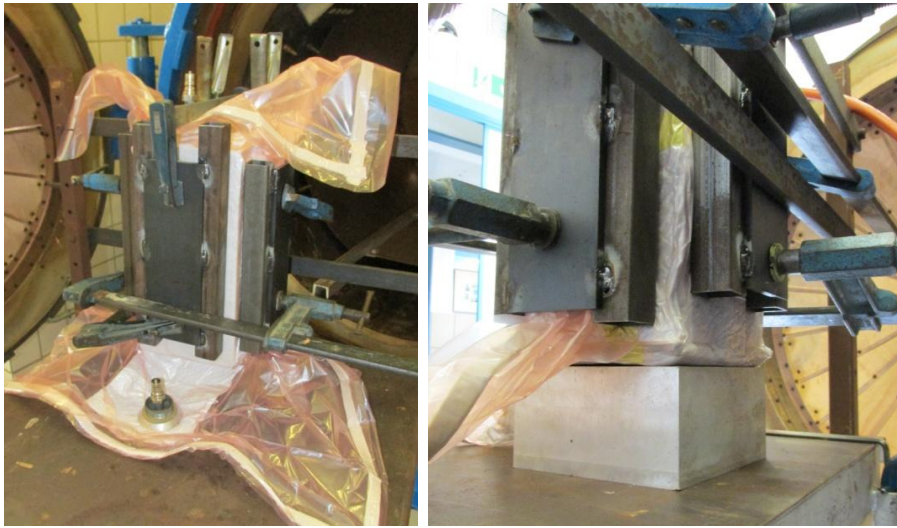
Figura 3.1.28. Configuración final fijada a la estructura auxiliar del autoclave.
