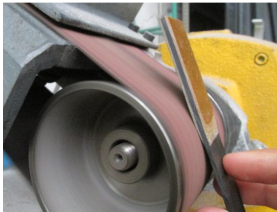
Figura 3.2.20. Lijado de los tacos de vidrio de cada esquina reentrante.
