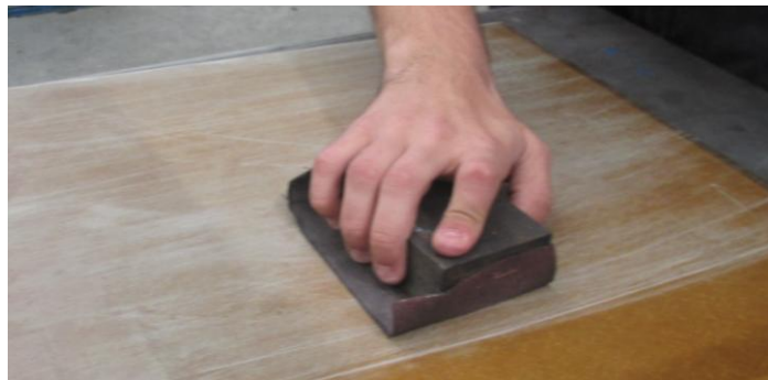
Figura 3.1.44. Lijado del panel de material compuesto de vidrio.
