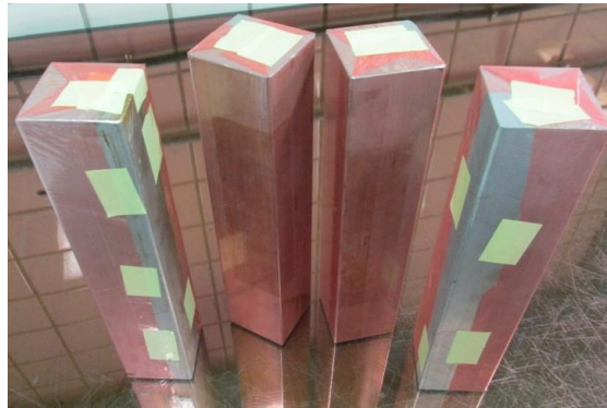
Figura 3.1.17. Tacos de aluminio recubiertos de teflón.
