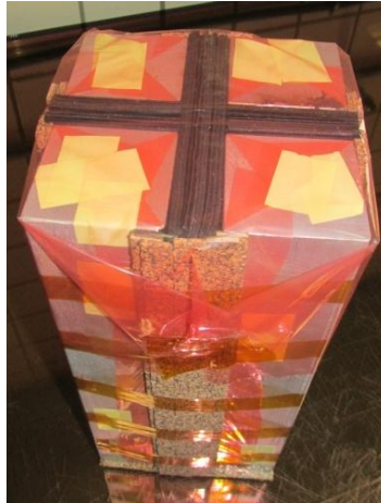
Figura 3.1.24. Colocación de teflón en la zona superior del bloque.
