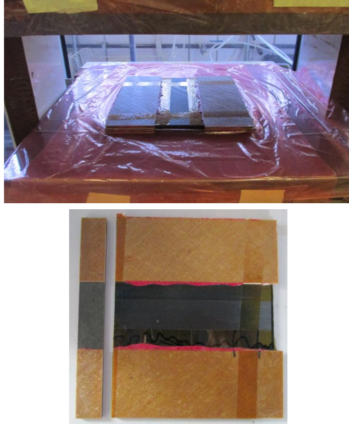
Figura 3.2.18. Eficiencia de la cinta de alta temperatura para eliminar el rebose de adhesivo con facilidad.
