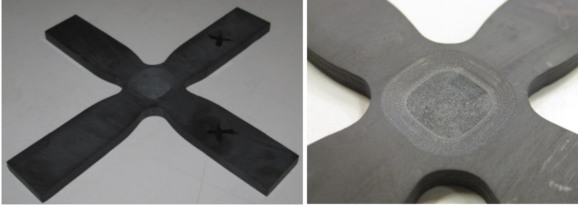
Figura 3.1.43. Mecanizado de las probetas cruciformes siguiendo el modelo M2 de [3].
