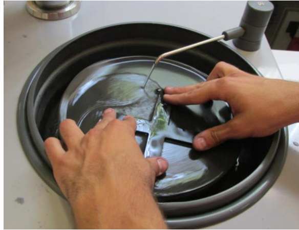
Figura 3.1.38. Lijado de las probetas cruciformes tras su cortado.
