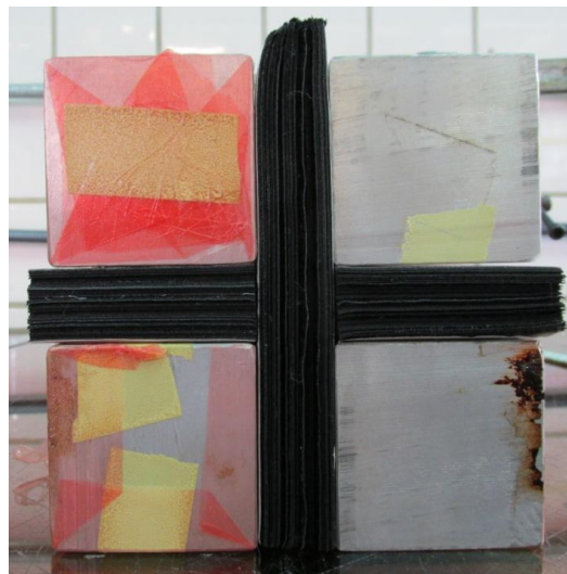
Figura 3.1.15. Posicionamiento de los laminados en la cruceta.
