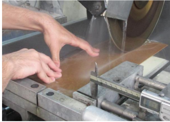
Figura 3.2.12. Cortado del panel de fibra de vidrio en tiras.
