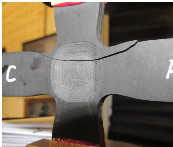
Figura 4.3.6. Zona de rotura de la probeta 3.
