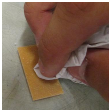
Figura 3.1.47. Limpieza con acetona de un taco de vidrio.
