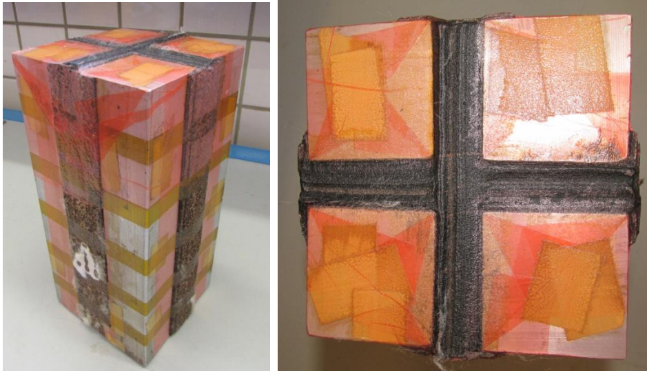
Figura 3.1.32. Retirada del recubrimiento de teflón y 'air wave'.
